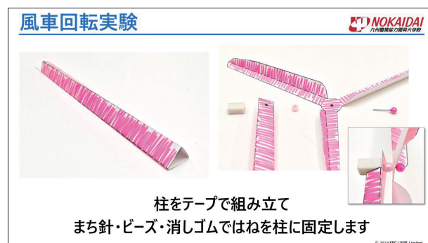
図9 柱に羽根を固定する手順
