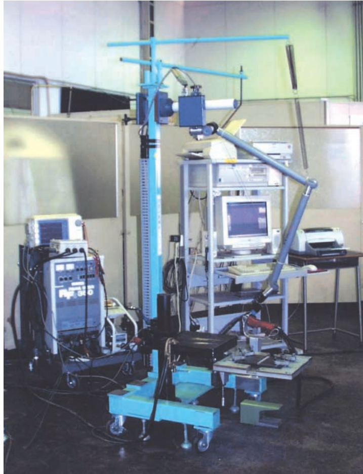
図4-6 溶接技能解析システムの外観
