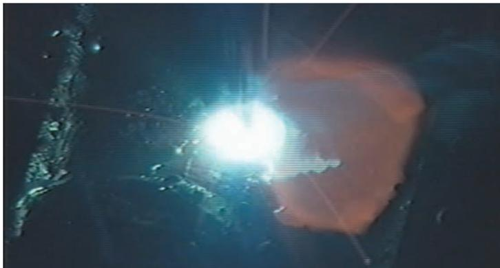
⑧19mm板・4層目1パス目溶接・通常電流値(180A)・後退法
