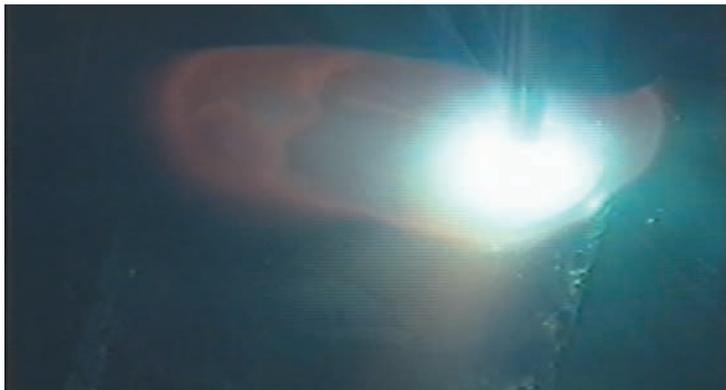
⑬12mm板・4層目溶接・低電流値（120A）・後退法
