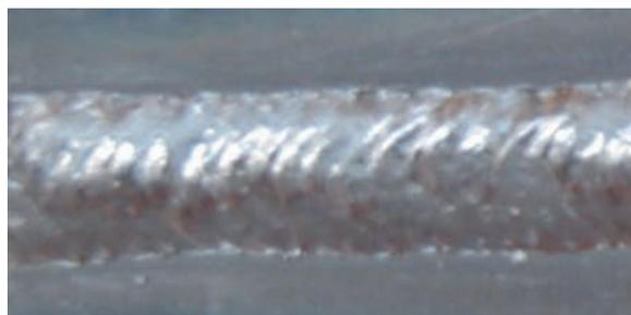
図6-13 高度熟練技能者の12mm板の溶接作業結果（ビード形状）
