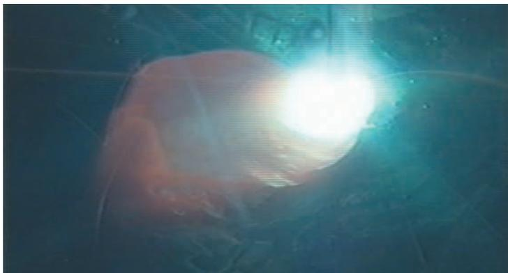
⑮19mm板6層目2パス目溶接・通常電流値（180A）・後退法
