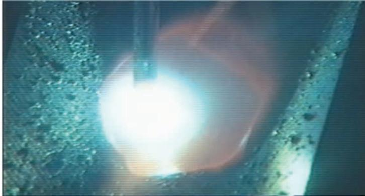
⑨12mm板・2層目溶接・低電流値（120A）・後退法
