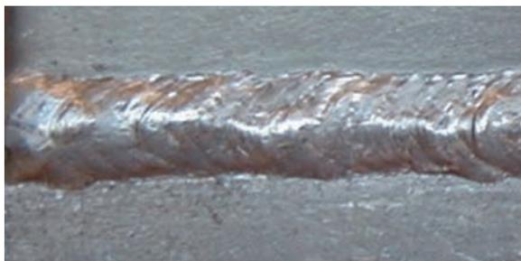
図6-27 一般技能者の9 mm板の溶接作業結果（ビード形状）
