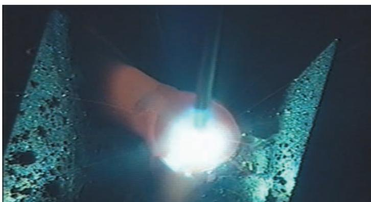
⑳19mm板・4層目2パス目溶接・低電流値（120A）・前進法
