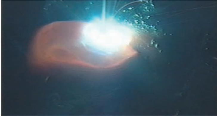
⑬19mm板・5層目2パス目溶接・通常電流値（180A）・後退法
