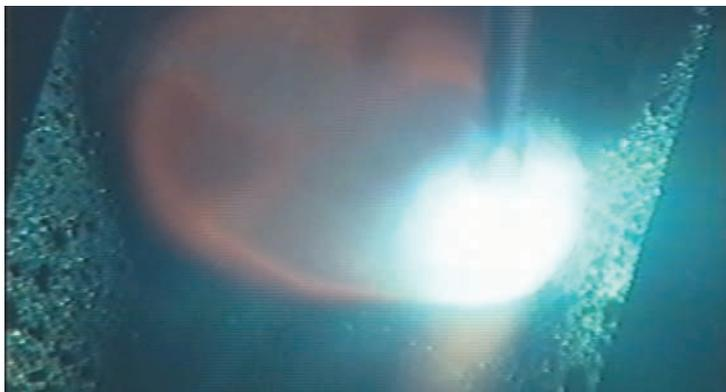
⑪12mm板・3層目溶接・低電流値（120A）・後退法
