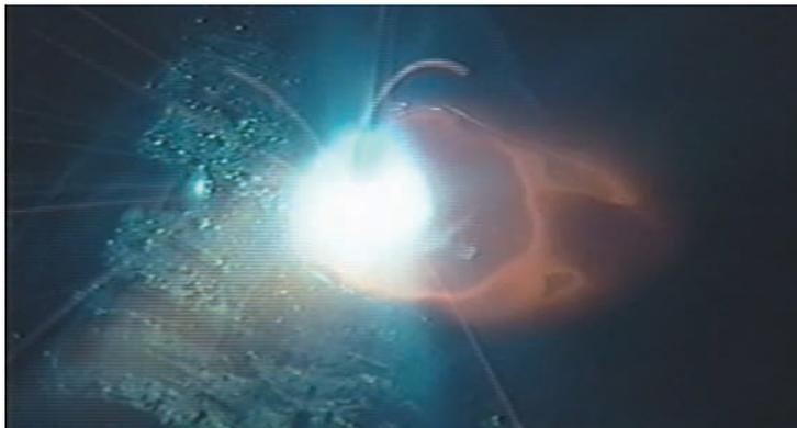
㊹19mm板・5層目1パス目溶接・低電流値(120A)・後退法
