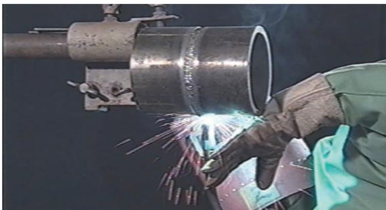
図6-3 高度熟練技能者による丸鋼管溶接の実技
