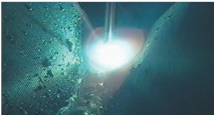
⑰19mm板・2層目溶接・低電流値（120A）・後退法
