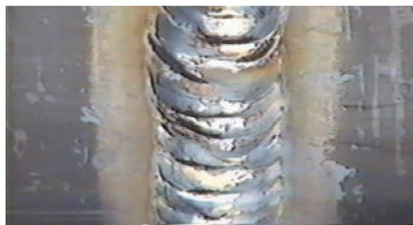
図6-11 高度熟練技能者の丸鋼管溶接作業結果
