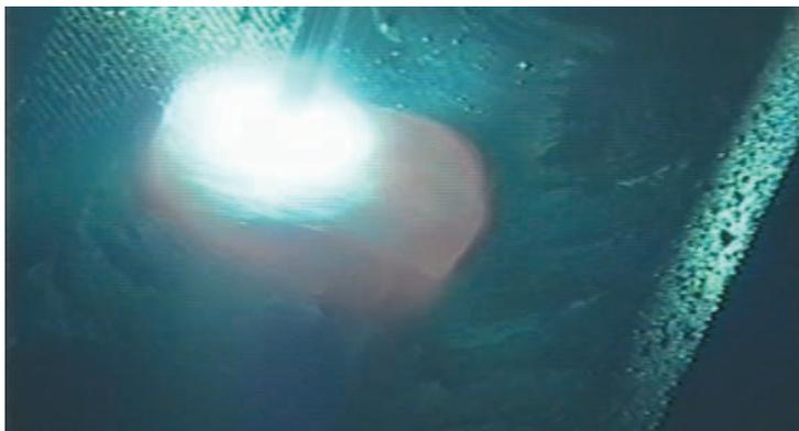
⑬19mm板・4層目2パス目溶接・低電流値（120A）・後退法
