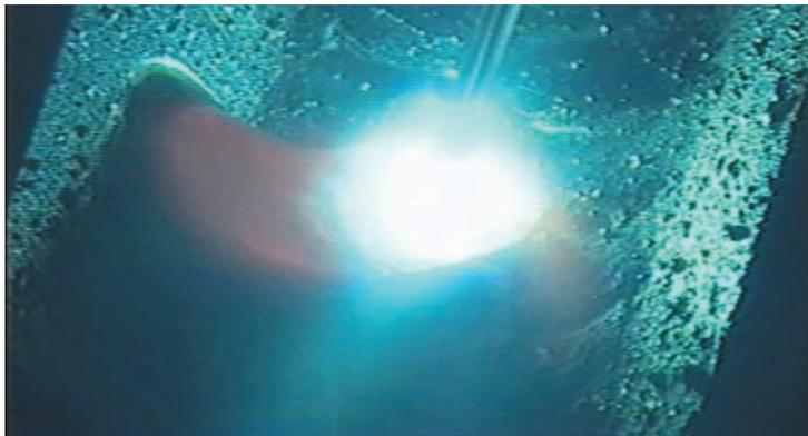
㉒19mm板・4層目2パス目溶接・低電流値（120A）・後退法
