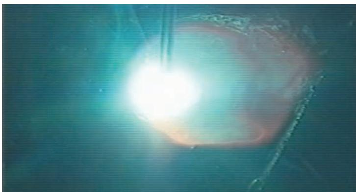
⑩19mm板・5層目1パス目溶接・通常電流値(180A)・後退法
