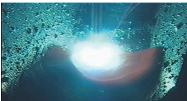
⑲19mm板・4層目1パス目溶接・低電流値（120A）・前進法
