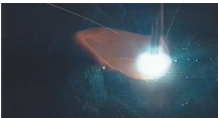
⑫19mm板・5層目1パス目溶接・通常電流値（180A）・後退法
