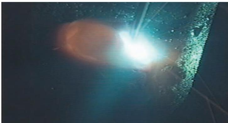
⑨19mm板・4層目2パス目溶接・通常電流値(180A)・後退法
