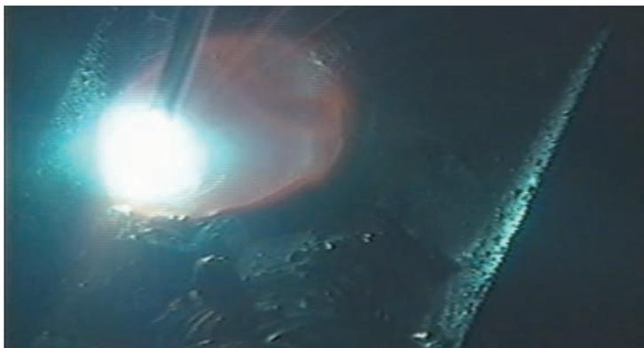
㊹19mm板・5層目2パス目溶接・低電流値(120A)・前進法
