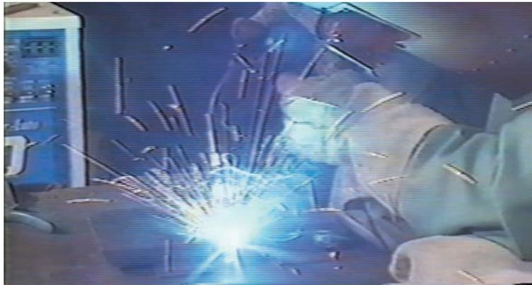
図6-9 19mm板の溶接における高度熟練技能者の溶融姿勢
