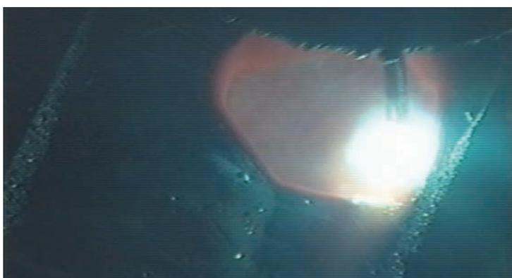
㊺19mm板・5層目1パス目溶接・低電流値(120A)・後退法
