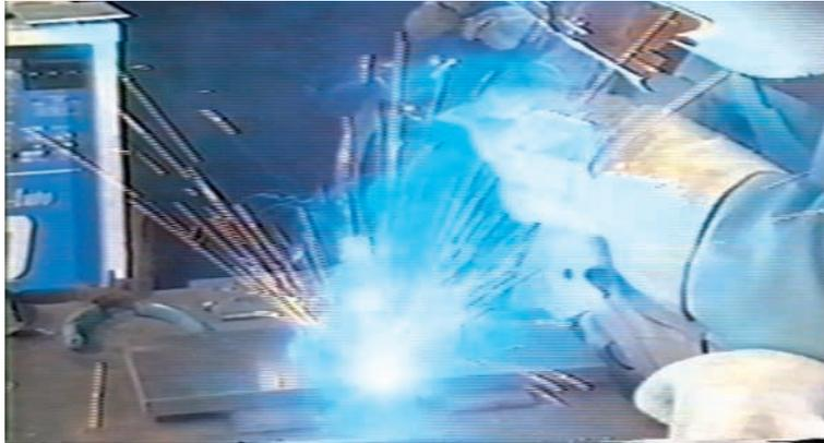
図6-7 12mm板の溶接における高度熟練技能者の溶接姿勢
