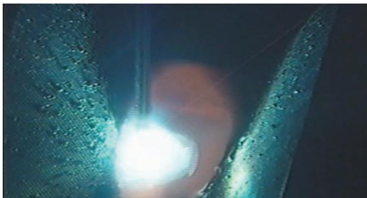
③19mm板・2層目溶接・通常電流値(180A)・後退法
