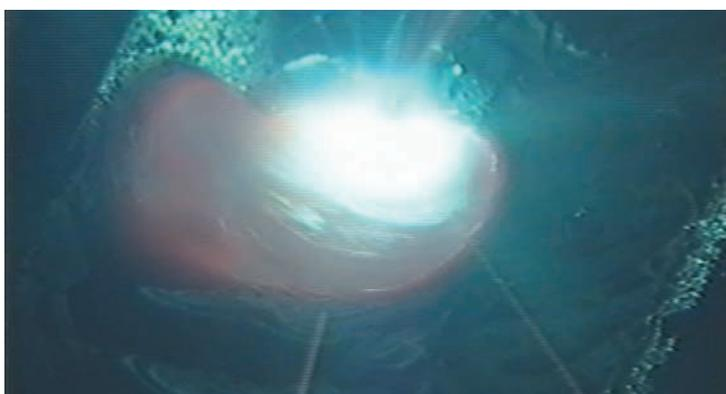
㊻19mm板・5層目2パス目溶接・低電流値(120A)・後退法
