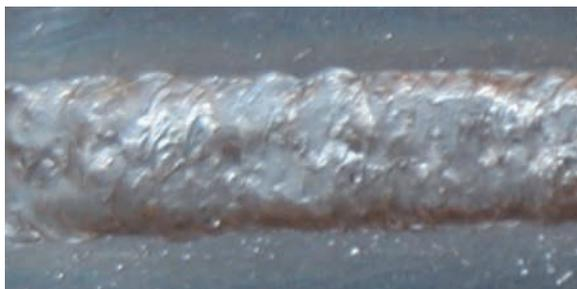
図6-28 一般技能者の12mm板の溶接作業結果（ビード形状）
