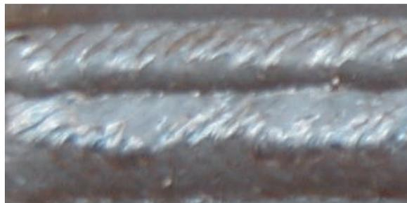
図6-14 高度熟練技能者の19mm板の溶接作業結果（ビード形状）
