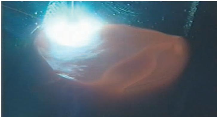
⑥12mm板・1層目溶接・低電流値（120A）・前進法
