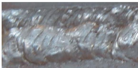
図6-29 一般技能者の19mm板の溶接作業結果（ビード形状）
