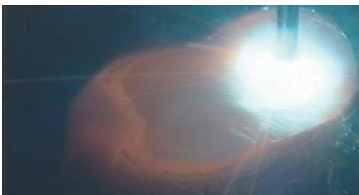
⑥ 9 mm板・2層目溶接・低電流値（120A）・前進法
