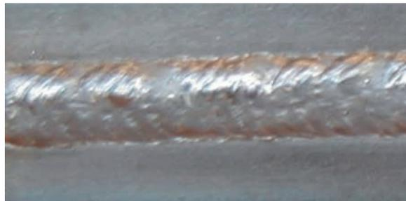
図6-12 高度熟練技能者の9 mm板の溶接作業結果（ビード形状）
