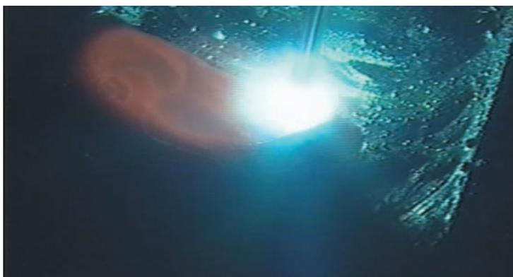
㊺19mm板・5層目2パス目溶接・低電流値(120A)・後退法
