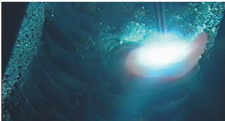
㉓19mm板・5層目1パス目溶接・低電流値（120A）・前進法
