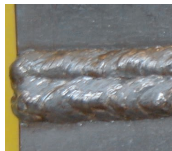
図7-25 19mm板のビード外観の比較
