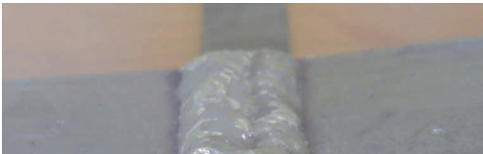
図7-20 高度熟練技能者と一般技能者における余盛りの高さの比較
