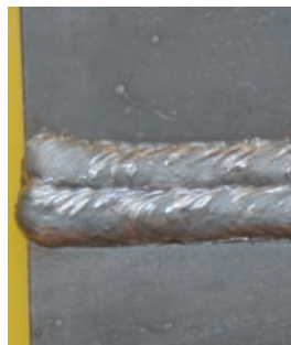
図7-25 19mm板のビード外観の比較
