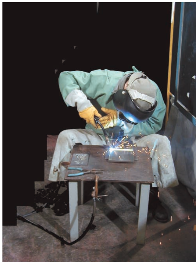
図7-4 一般技能者のトーチの持ち方
