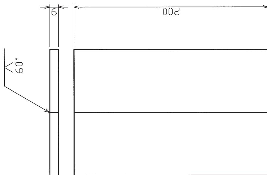
下向き突合せ溶接（厚板）
