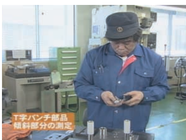
傾斜のあったT字パンチを 測定し誤差を確認。
