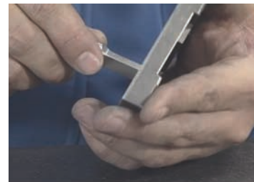
ストリッププレートの調整。面取り作業。高度熟練技能者
