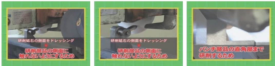
研削砥石側面のドレッシング
