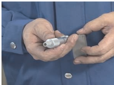
T字パンチを測定する、 高度熟練技能者
