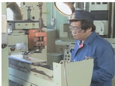
研削盤の砥石を調整。 高度熟練技能者
