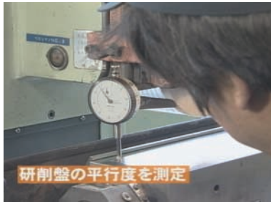
ダイヤルゲージで研削盤の平行度を測定。 高度熟練技能者
