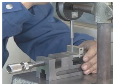
研削する T 字パンチ 部品を精密バイスに 設置し、平行度を調 整する、 高度熟練技能者
