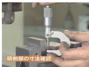
研削時丁寧に寸法確認をする。 高度熟練技能者
