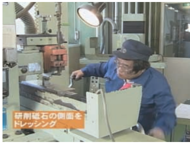
研削砥石の側面をドレッシングする。 高度熟練技能者
