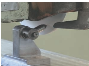
研削盤の砥石を調整する、 高度熟練技能者
