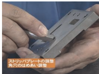
ストリッププレートの調整。面取り作業。高度熟練技能者
