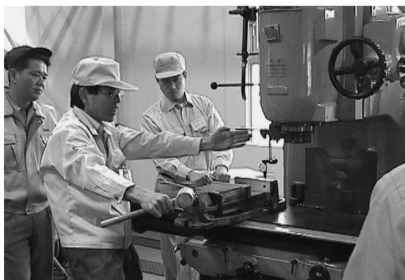
写真2-1は、第1日目午前、機械精度検査の技能提示である。
