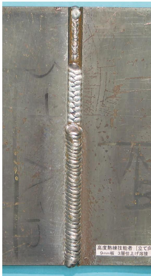
(注) 高度熟練技能者の9 mm 板溶接の完成品の写真
