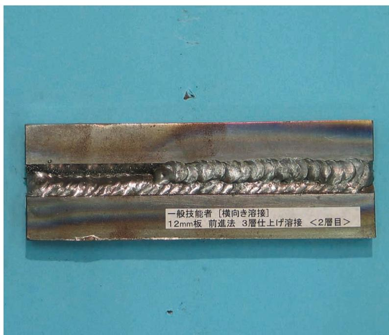
(注) いずれも12 mm 板前進法溶接で、2層目まで溶接した溶接結果の写真。
