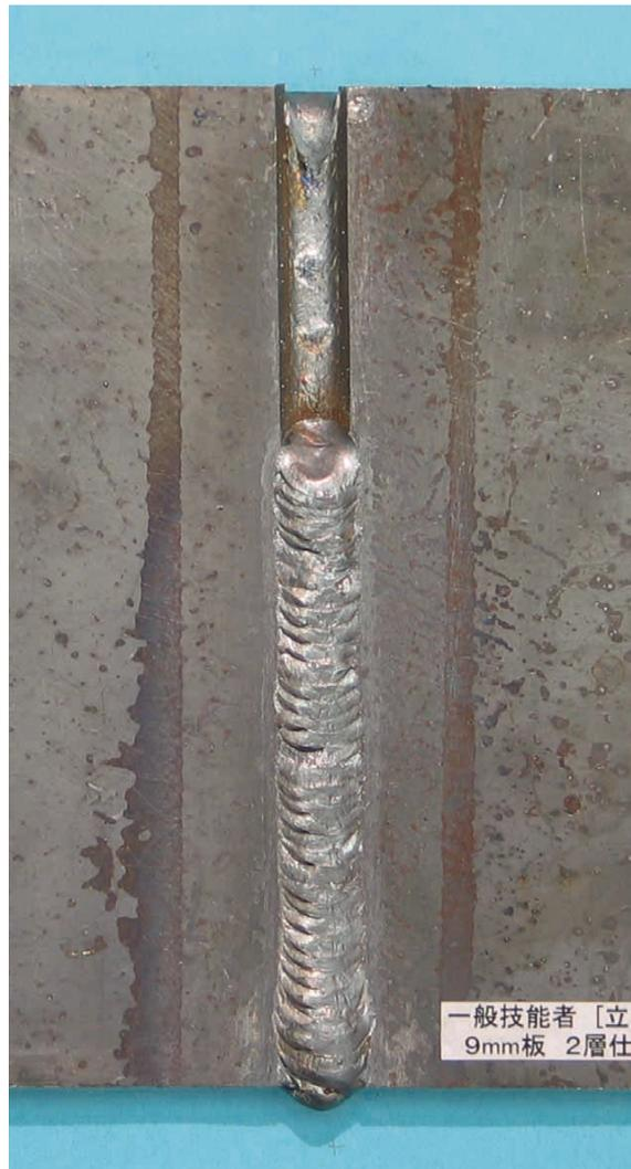
(注) 一般技能者の9 mm 板2層仕上げ溶接の完成品の写真
