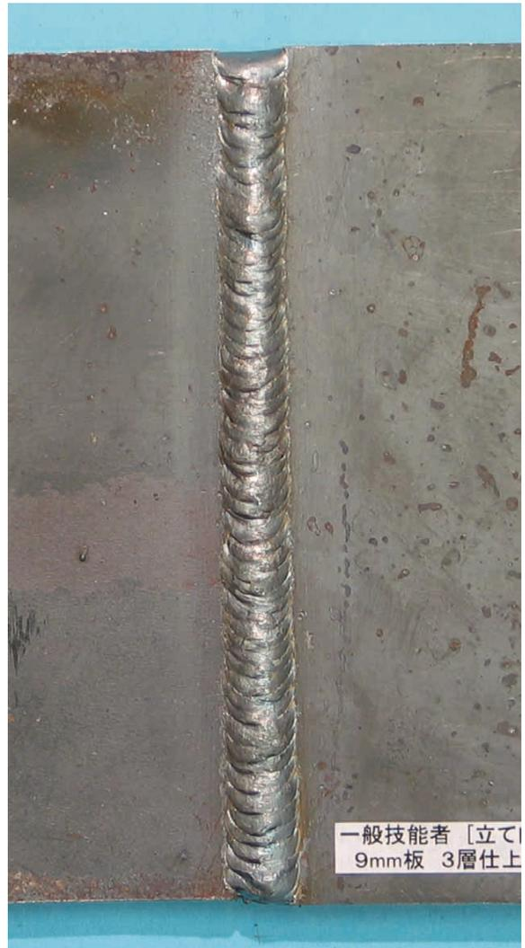
(注) 9 mm 板立て向き姿勢溶接の最終溶接結果
