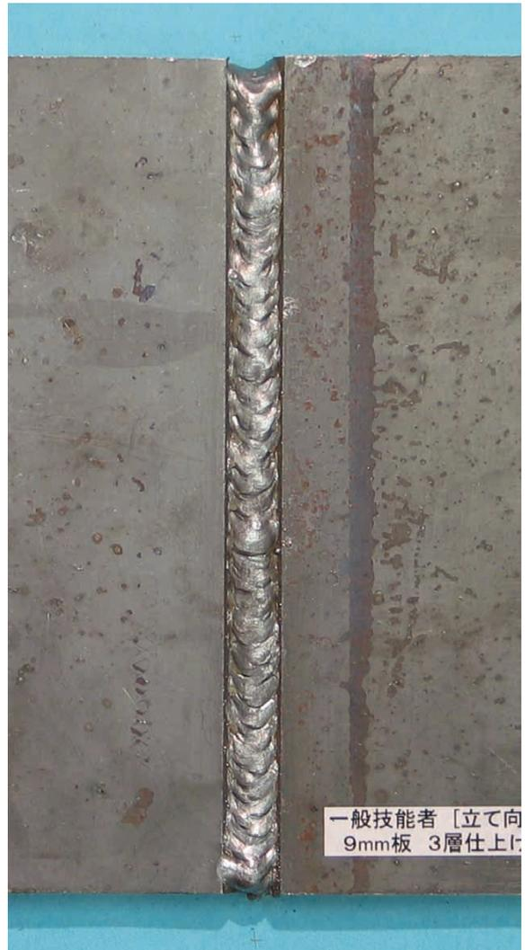
(注) いずれも9mm板溶接の写真。一般技能者は2層目まで溶接した結果の写真。
