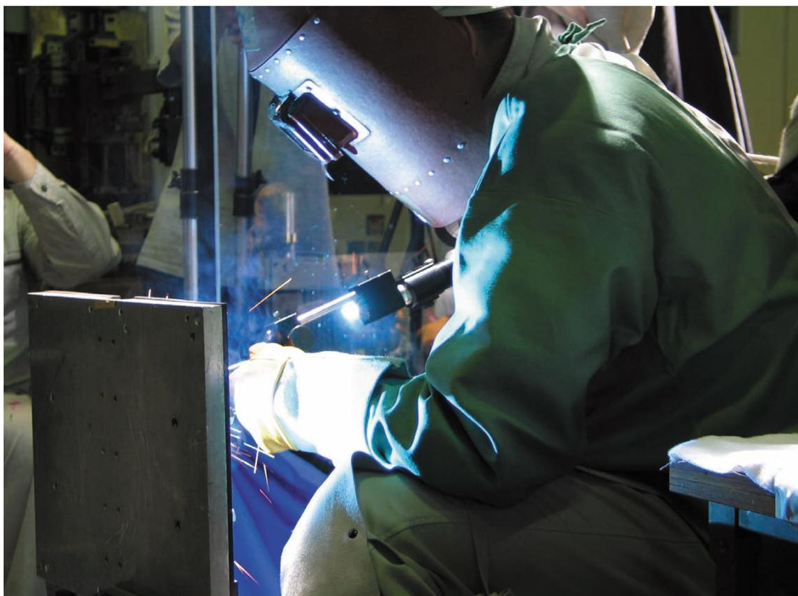
図7 - 1 立て向き姿勢溶接における高度熟練技能者の溶接姿勢
