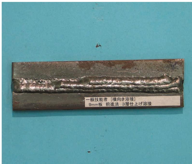
(注) いずれも 9 mm 板前進法溶接の完成品の写真。
