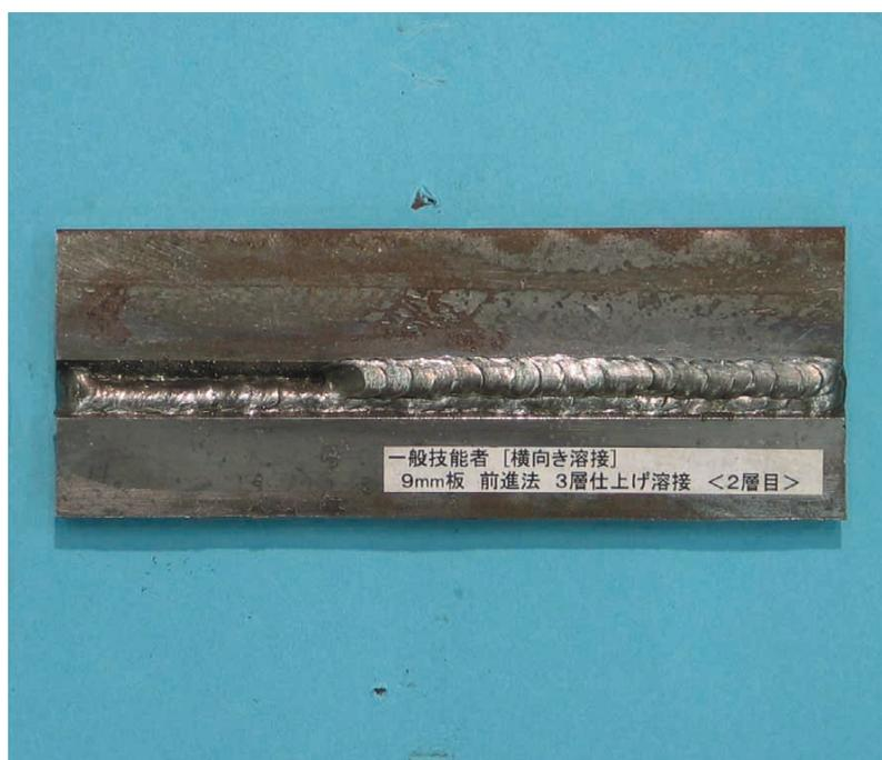
(注) いずれも 9 mm 板前進法溶接で、2 層目まで溶接した溶接結果の写真。
