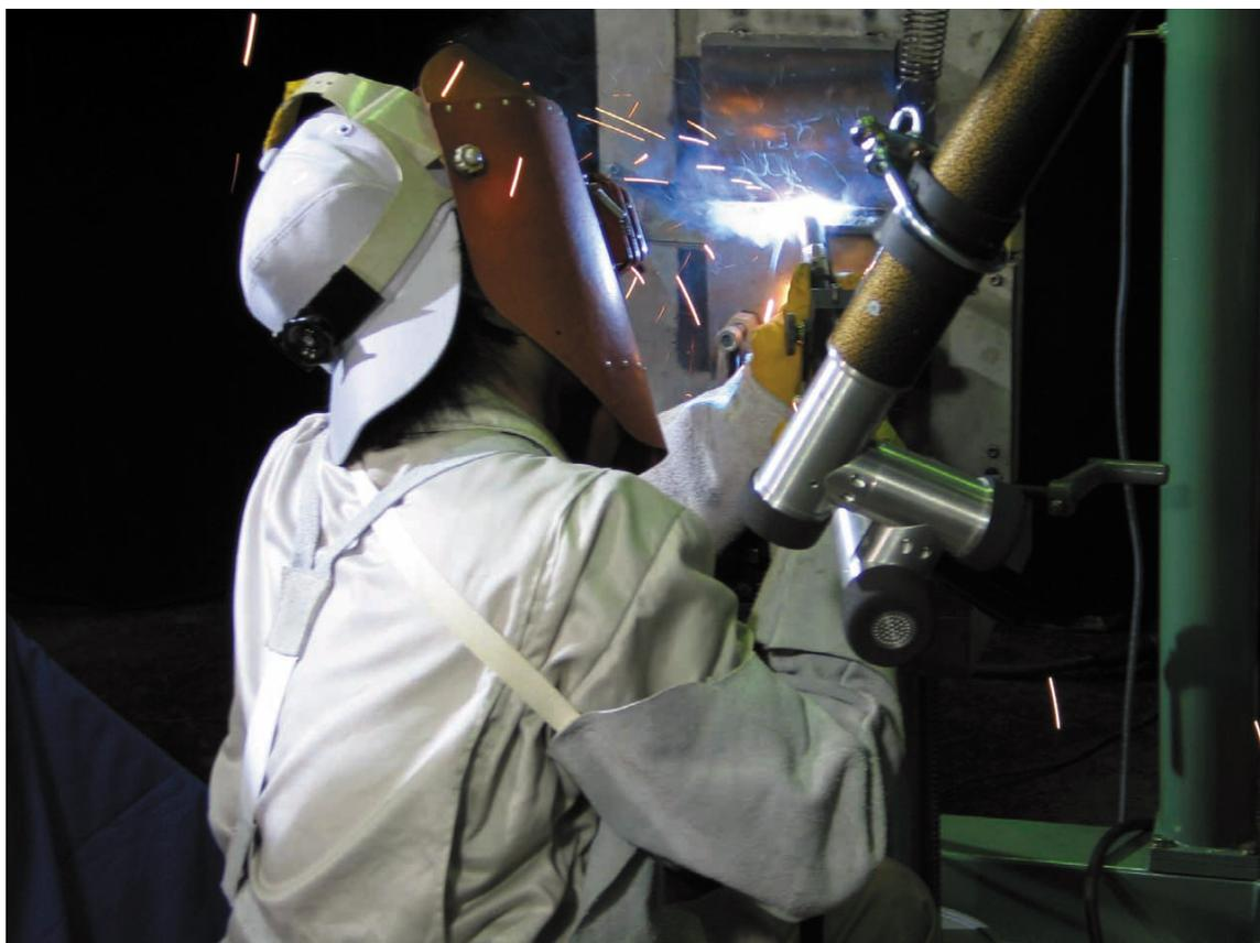
図7 - 26 横向き姿勢溶接における高度熟練技能者と一般技能者の溶接姿勢の比較
