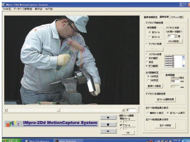
図2-8 二次元動作分析システムによる軌跡表示例
