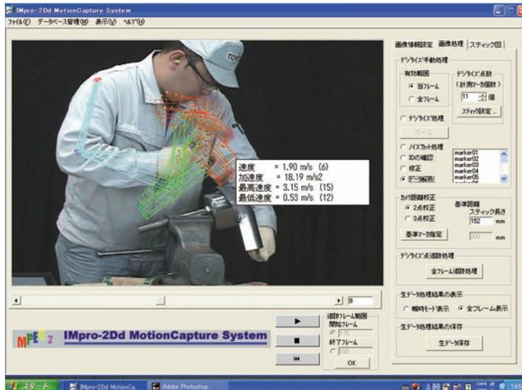
図2-7 二次元動作分析システムによる速度分析例
