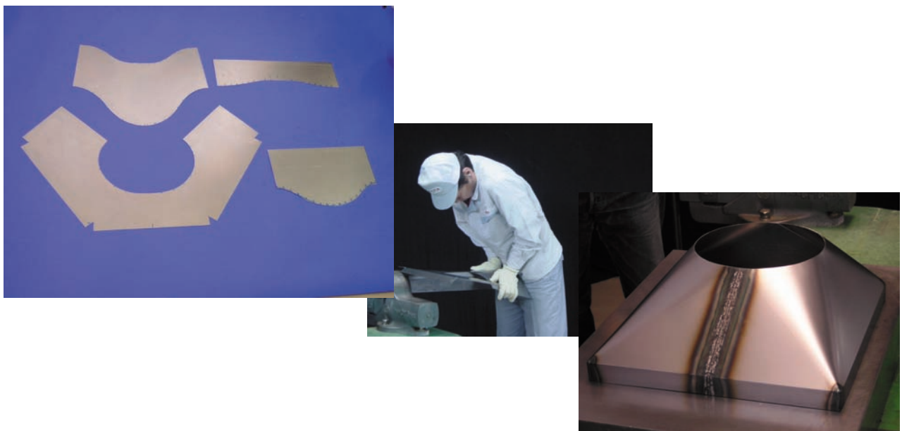
図3 - 7 曲げ板金の展開>加工>製品のプロセス
