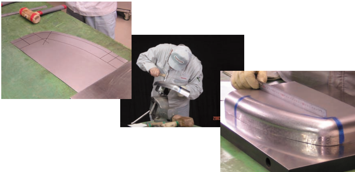
図3 - 6 自動車板金（絞り加工）の展開>加工>製品のプロセス
