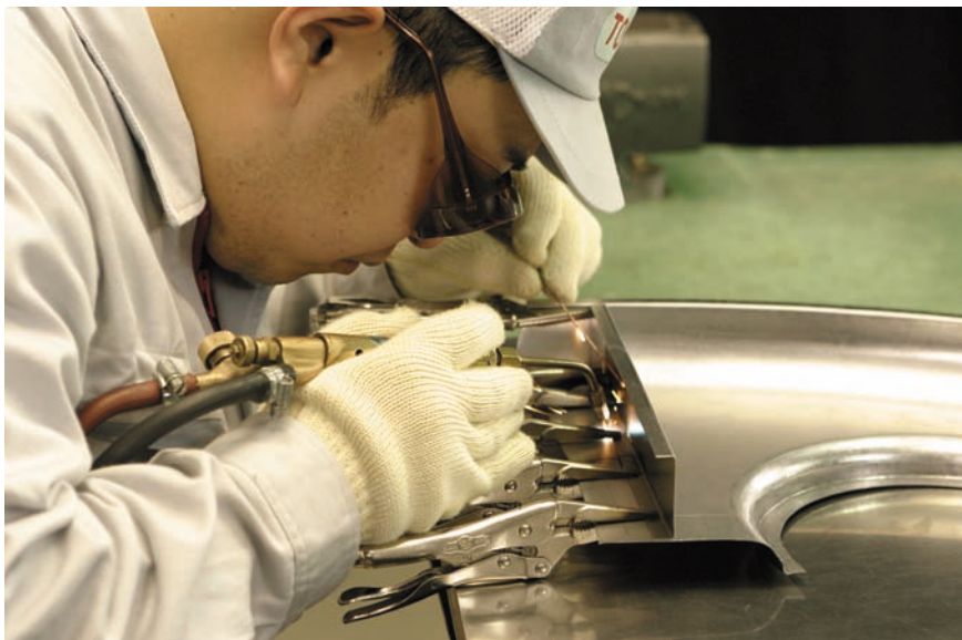
図7 - 83 補助材の仮付け溶接
