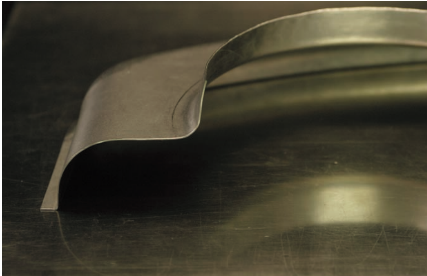
図7 - 60 アーチ部分の粗加工終了後の部品カット
