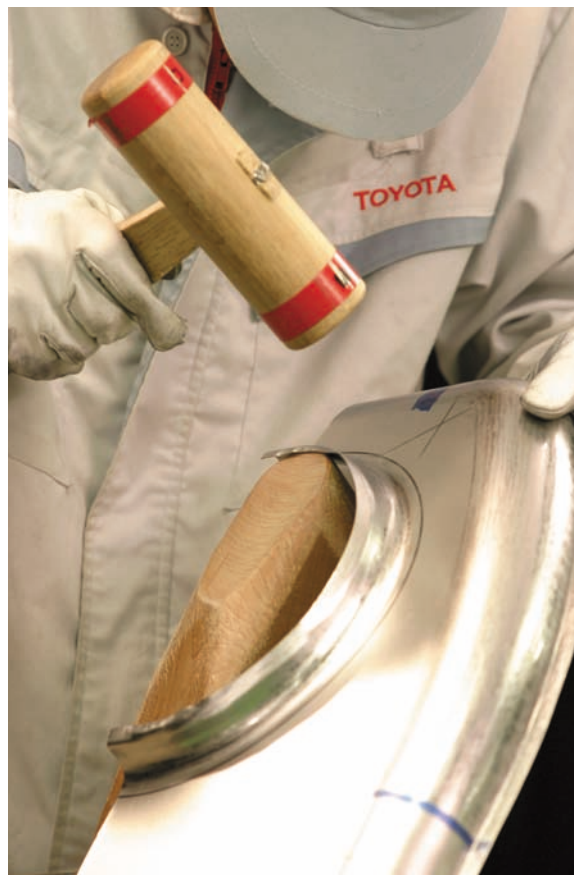
図7 - 123 アーチ部分フランジの粗加工
