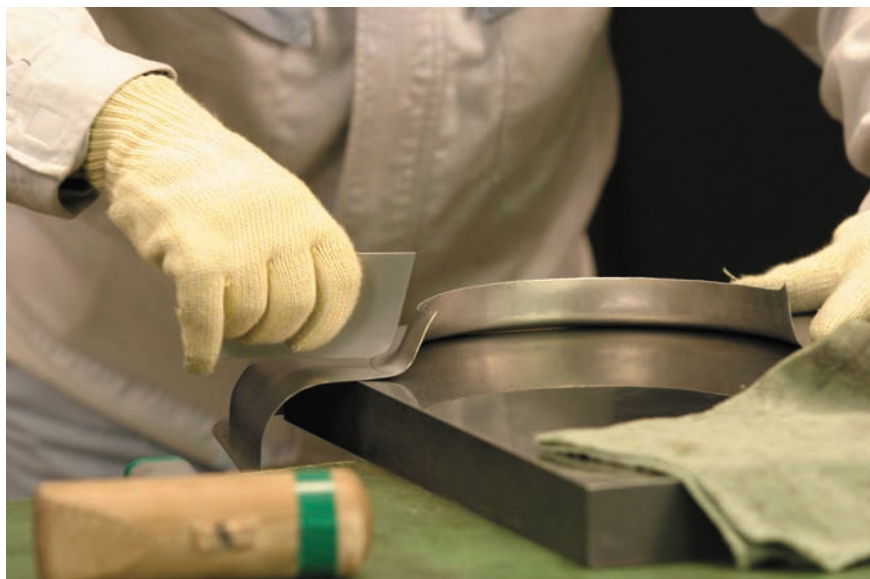
図7 - 59 アーチ部分の粗加工（その6）
