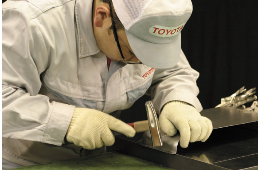
図7 - 46 本体フランジの仕上げとならし
