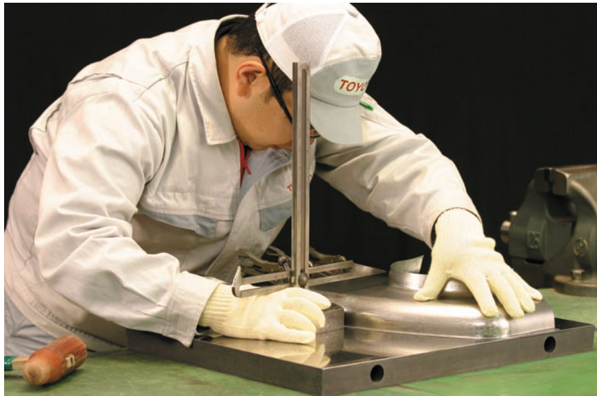
図7 - 64 アーチ部分フランジの寸法取り
