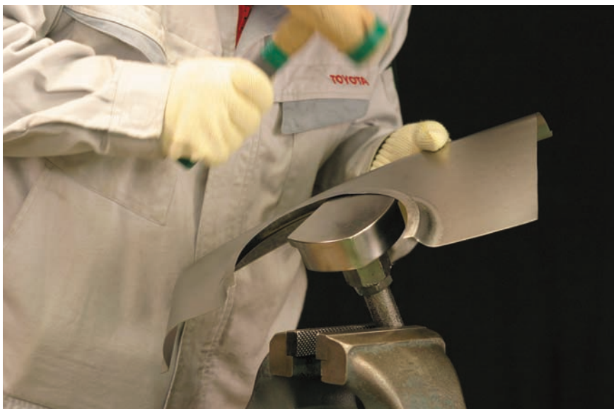
図7 - 69 アーチ部分フランジの粗加工（その4）
