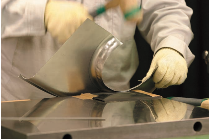
図7 - 56 アーチ部分の粗加工（その3）
