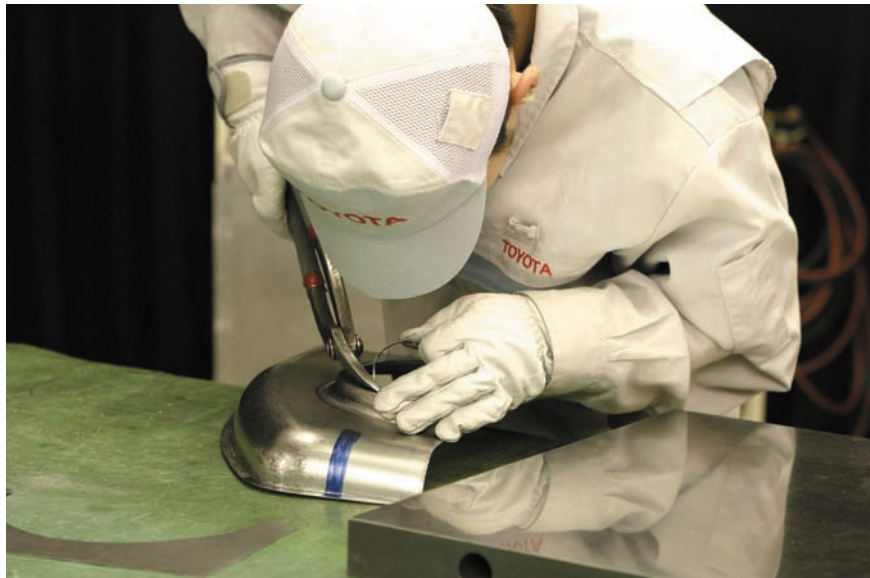
図7 - 126 アーチ部分フランジの余肉切断
