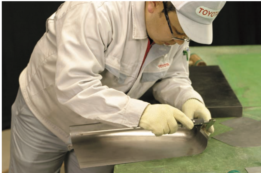
図7 - 48 本体フランジの寸法確認
