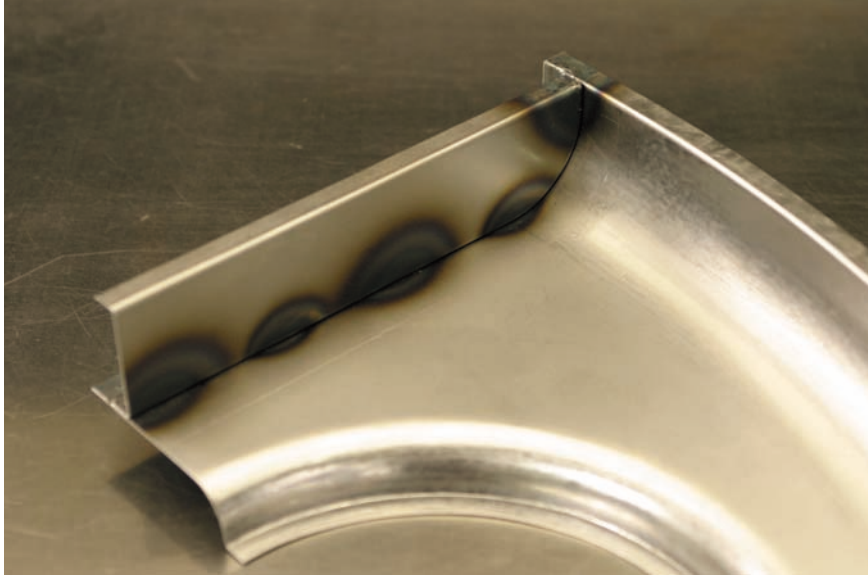
図7 - 96 完成した課題のカット（溶接部内側）
