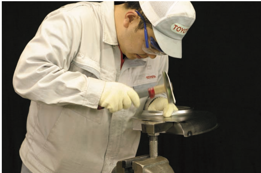
図7 - 84 仮付け溶接後のひずみ取り
