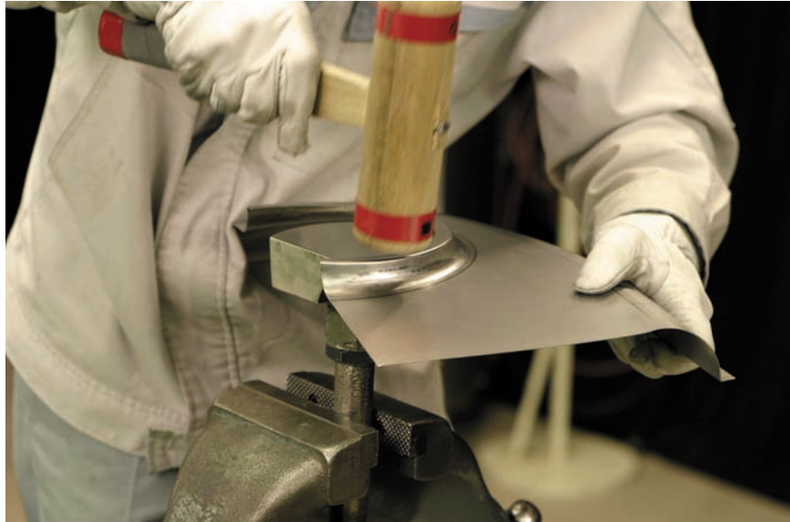
図7 - 124 アーチ部分フランジの修正
