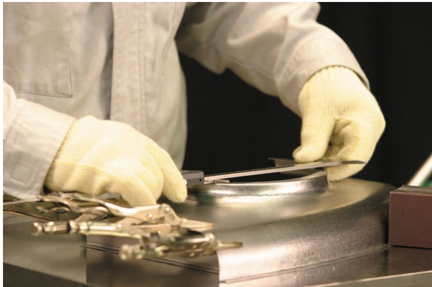
図7-78 アーチ部分フランジ寸法の確認(その2)
