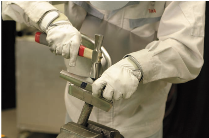
図7 - 120 アーチ部分のならし
