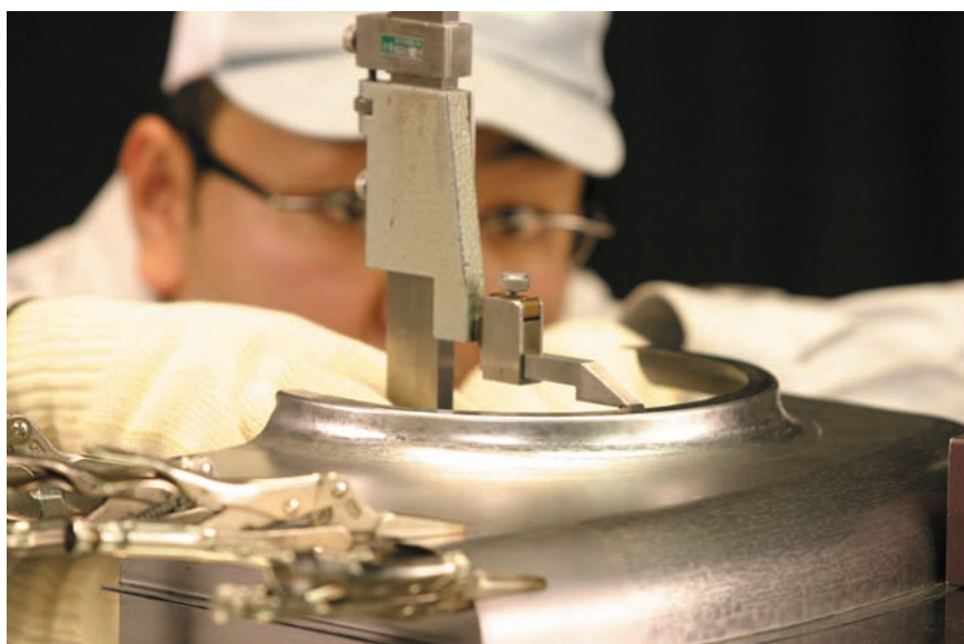
図7-77 アーチ部分フランジ寸法の確認(その1)
