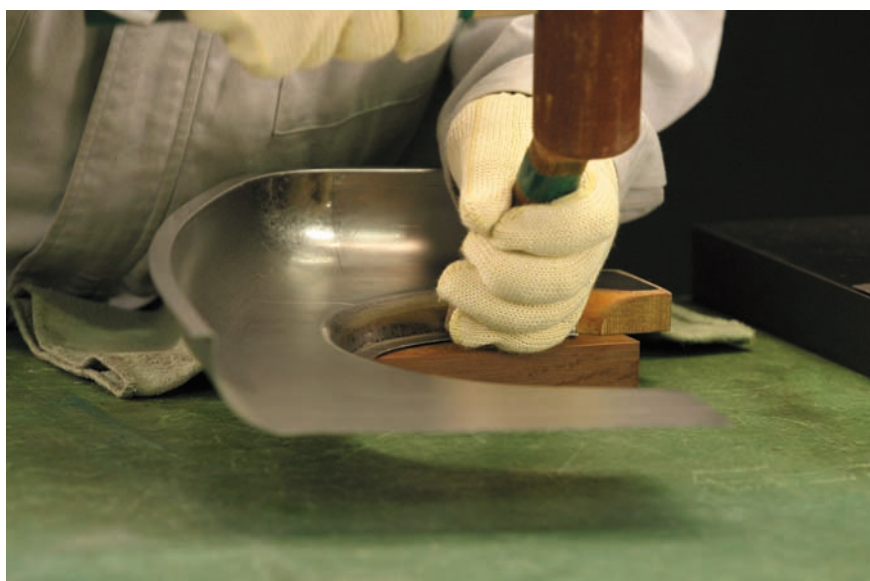
図7-71 アーチ部分フランジの粗加工（その6）
