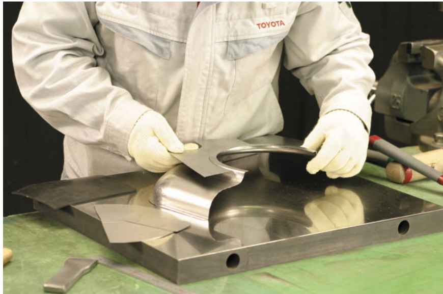
図7-76 アーチ部分フランジの修正(その4)
