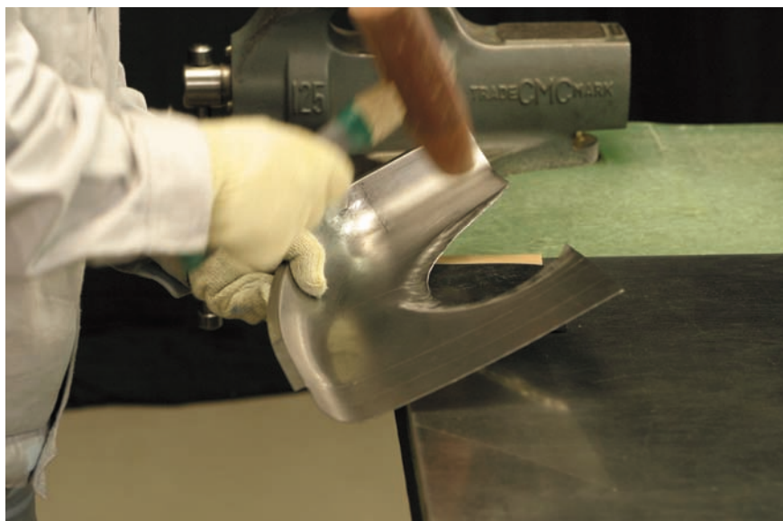
図7 - 55 アーチ部分の粗加工（その2）
