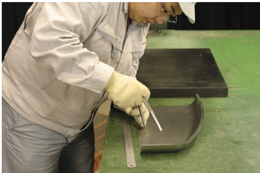
図7 - 51 アーチ部分の寸法取り(裏面)
