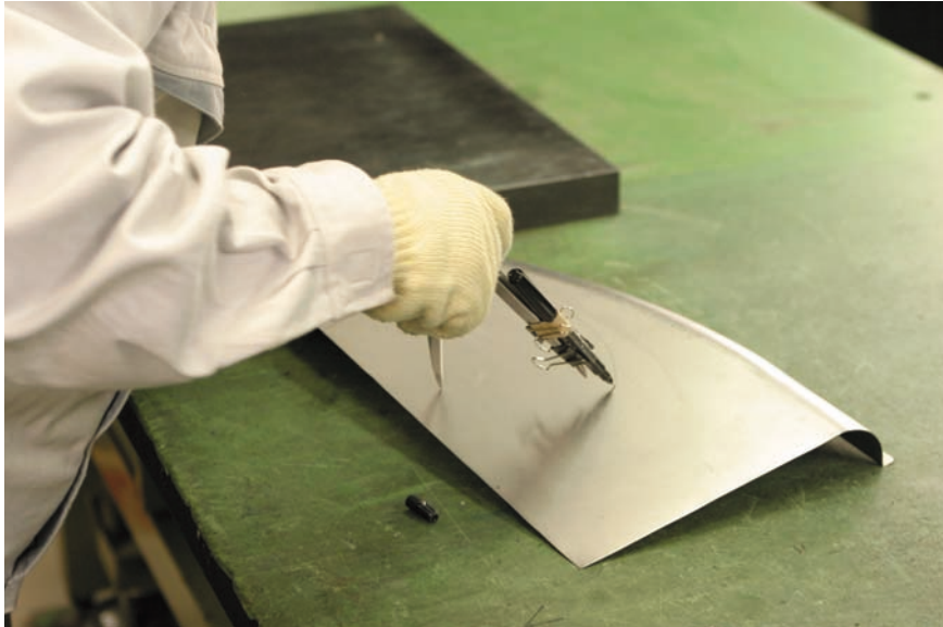
図7 - 52 アーチ部分の寸法取り（表面）
