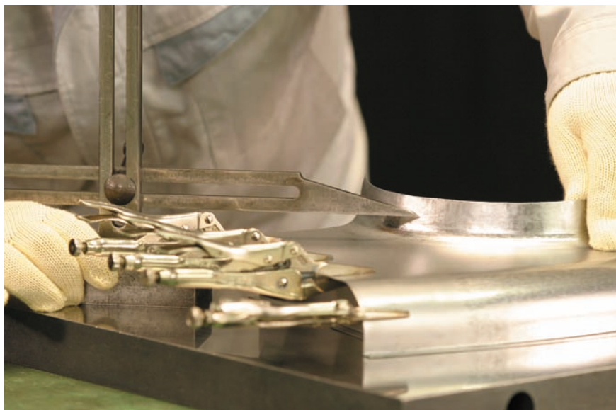
図7 - 65 アーチ部分フランジの余肉切断
