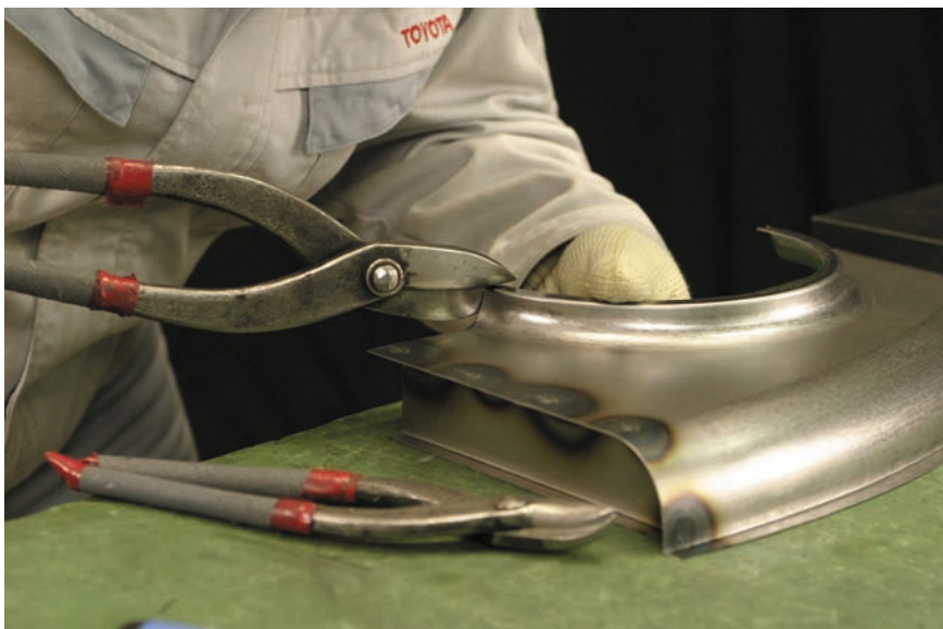
図7 - 93 本体余肉の切断（長手開放端）
