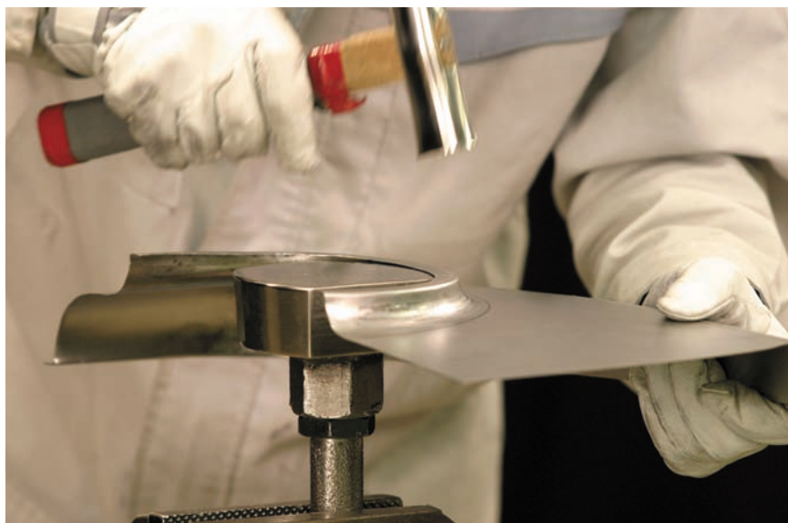
図7 - 125 アーチ部分フランジのならし
