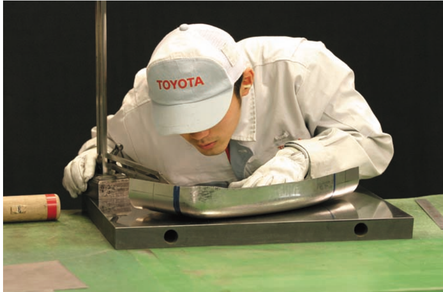
図7 - 106 本体フランジ用寸法取り
