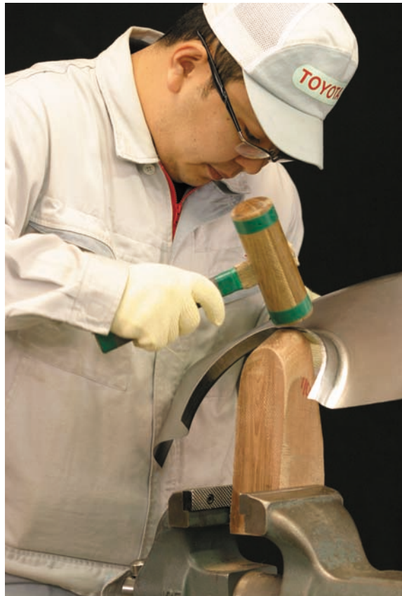
図7 - 66 アーチ部分フランジの粗加工（その1）
