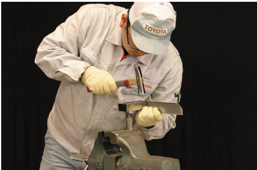
図7 - 9 補助材の仕上げとならし
