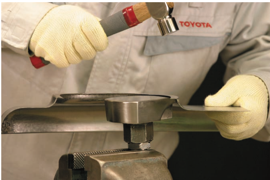
図7 - 73 アーチ部分フランジの修正（その1）
