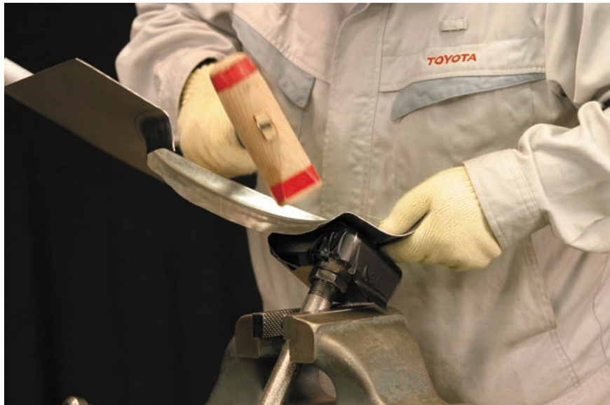
図7 - 58 アーチ部分の粗加工（その5）
