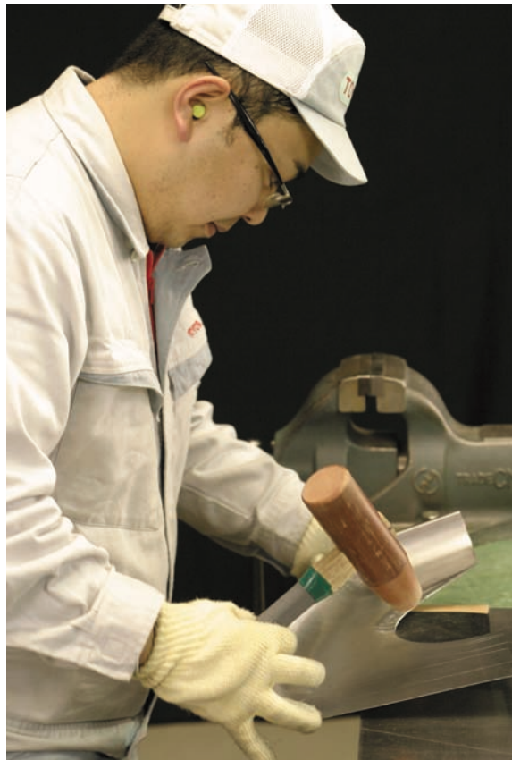
図7 - 54 アーチ部分の粗加工（その1）
