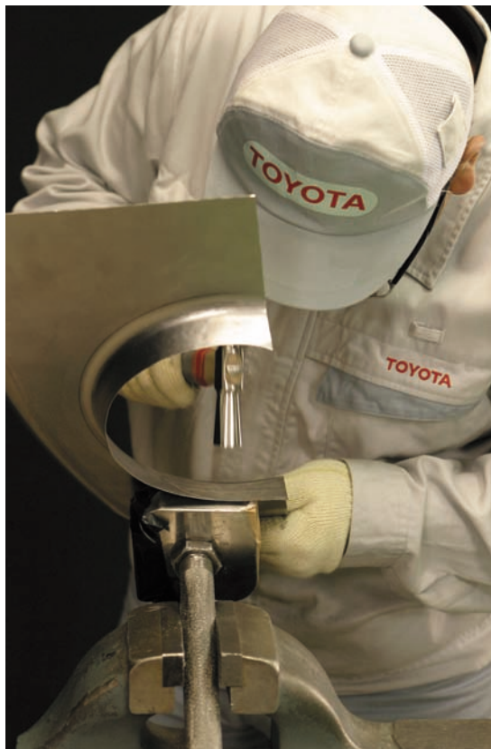
図7 - 61 アーチ部分のならし
