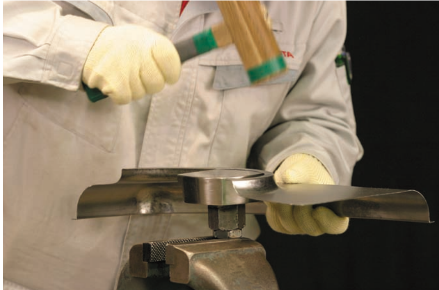
図7-70 アーチ部分フランジの粗加工（その5）
