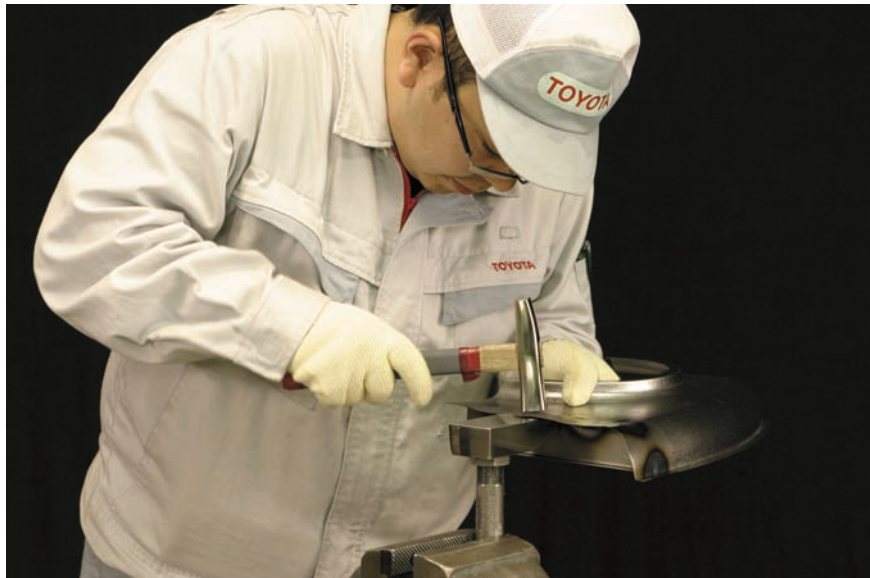
図7 - 86 補助材本溶接後のひずみ取り
