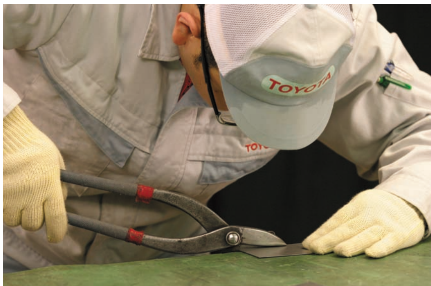
図7 - 7 補助材の切断
