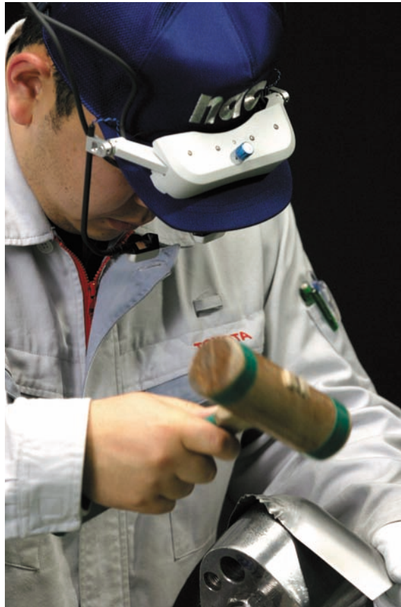
図7 - 138 高度熟練技能者のR55絞り加工
