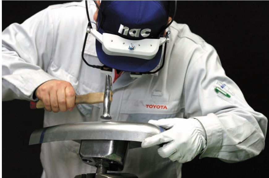
図7 - 136 高度熟練技能者のR 550ならし作業
