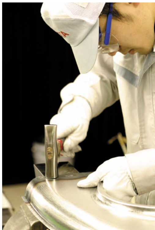
図7 - 131 本溶接後のひずみ取り
