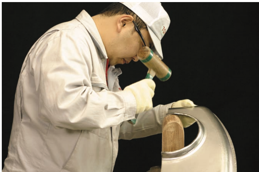
図7 - 67 アーチ部分フランジの粗加工（その2）
