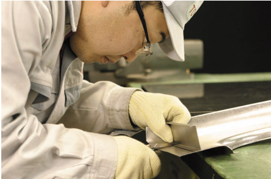
図7 - 82 補助材の仮組み
