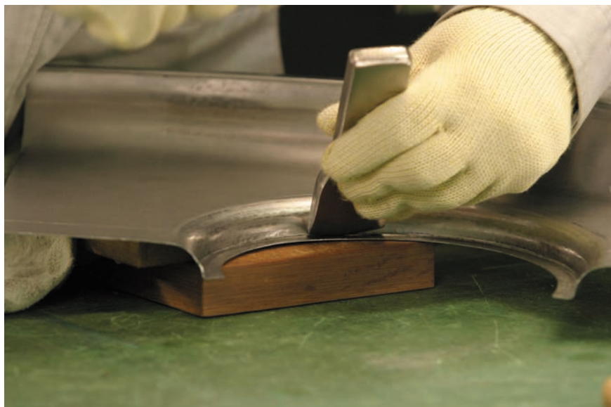
図7 - 75 アーチ部分フランジの修正（その3）
