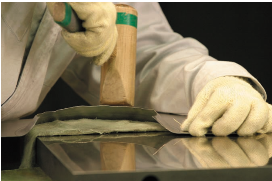
図7 - 57 アーチ部分の粗加工（その4）
