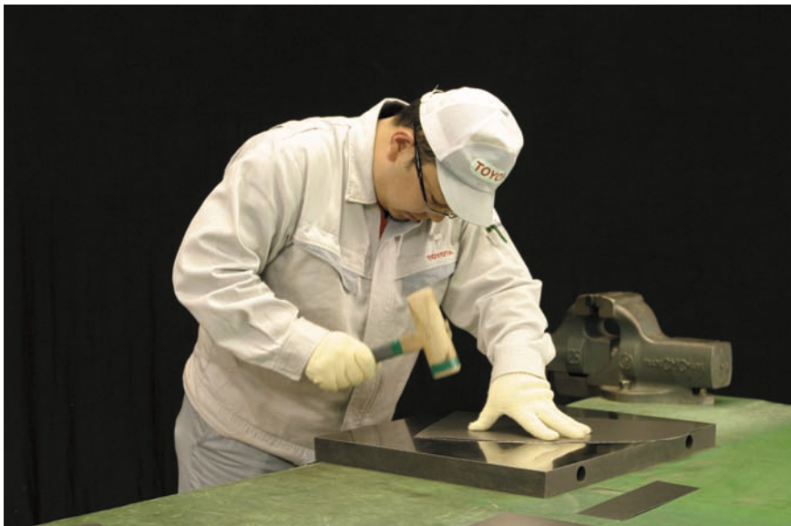
図7 - 5 切断後の部品の修正・ひずみ取り
