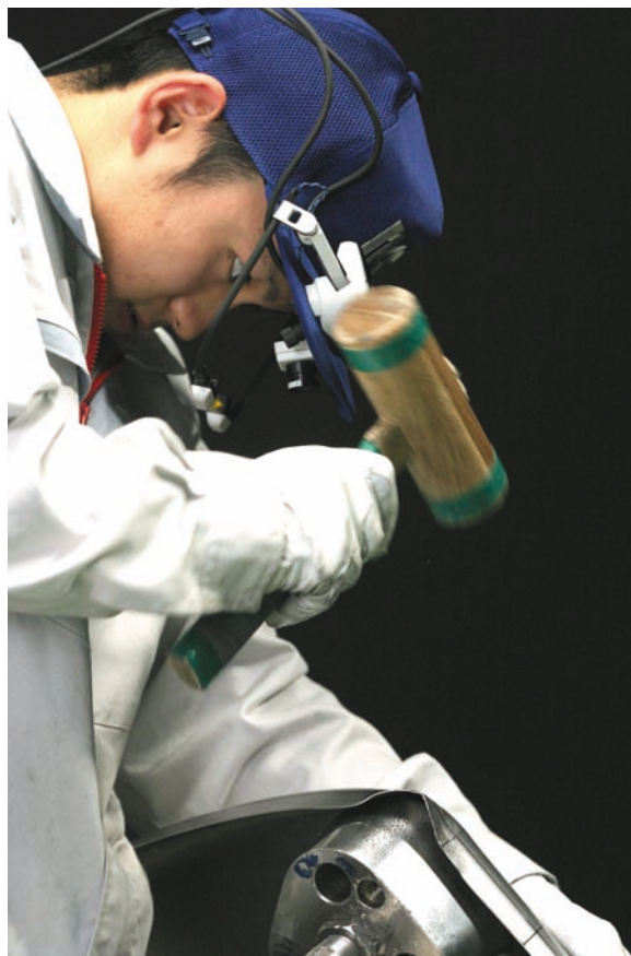
図7 - 139 高度熟練技能者のR55絞り加工
