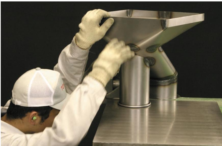
図9 - 149 高さ方向の寸法確認
