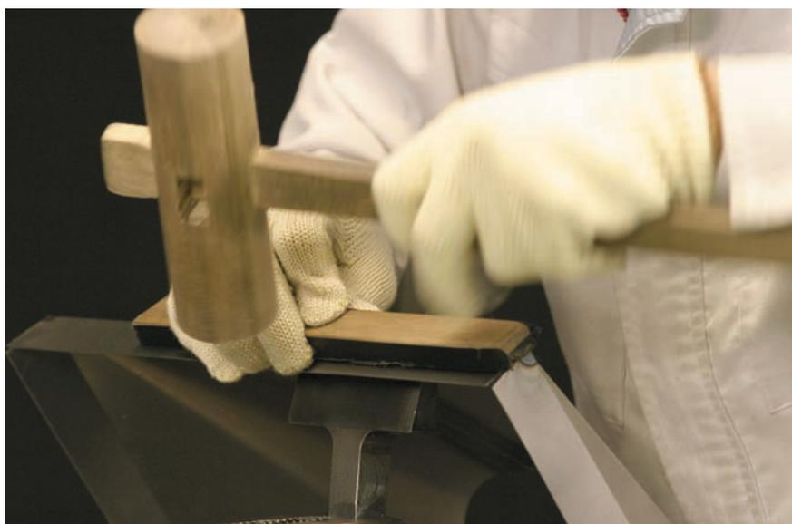
図9 - 20 ベースの直線曲げ（溶接箇所）
