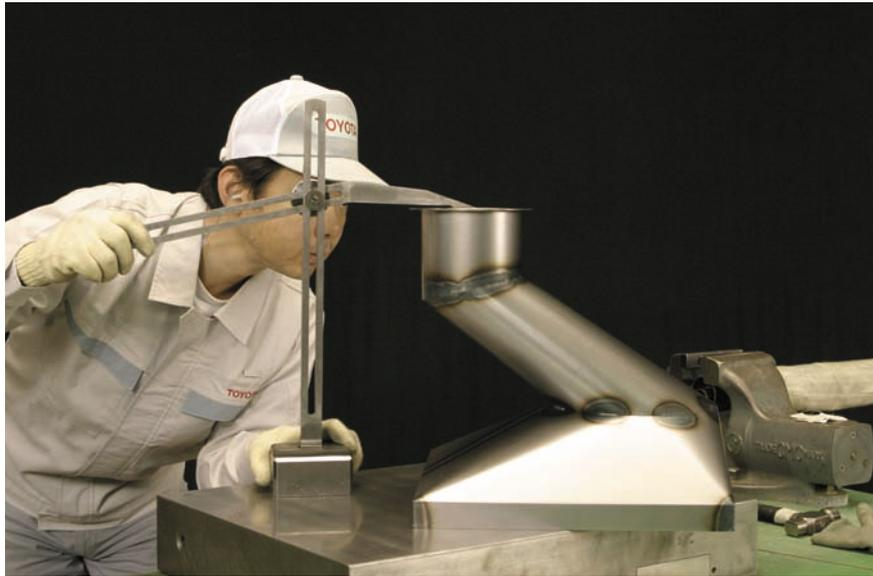
図9 - 91 溶接後の寸法確認
