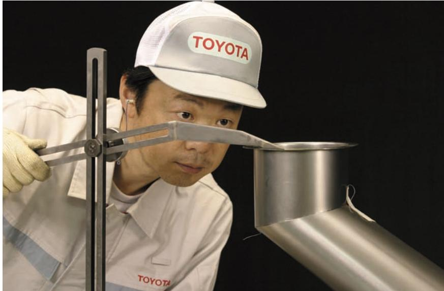
図9 - 87 中間体と楕円筒の組み付け位置確認（その2）
