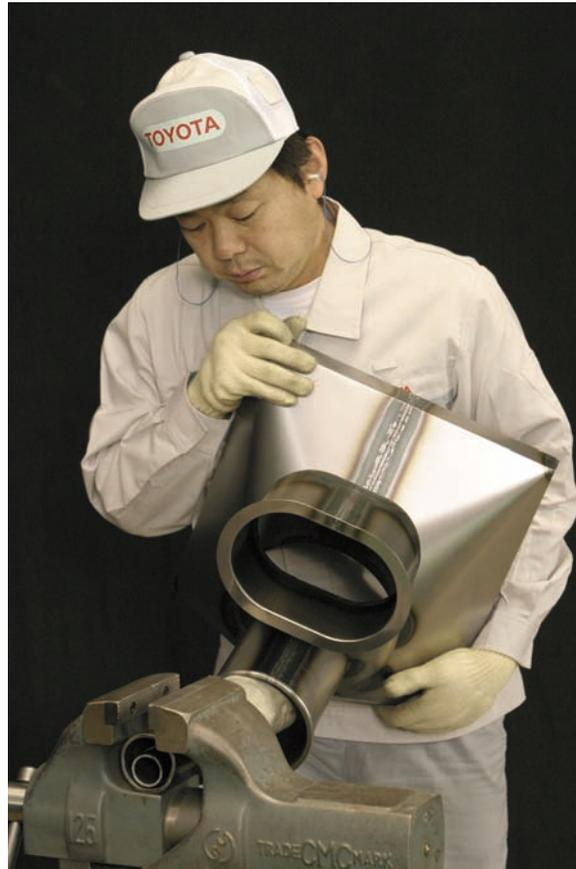
図9 - 109 本溶接後の修正
