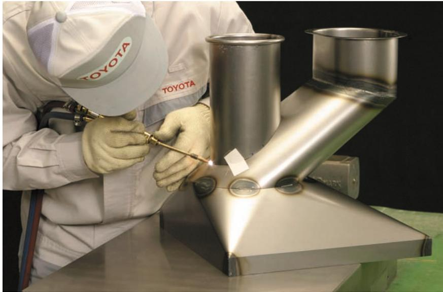
図9 - 107 中間体と円筒の仮付け溶接
