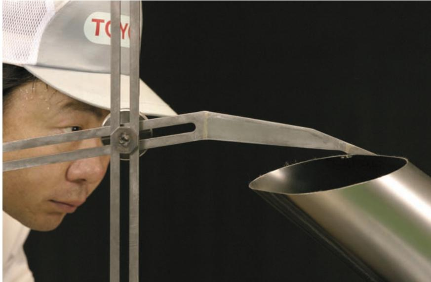
図9 - 77 ベースと中間体の組み付け寸法確認
