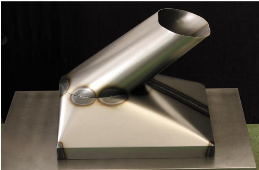
図9 - 139 ベースと中間体の組み付け後の部品カット
