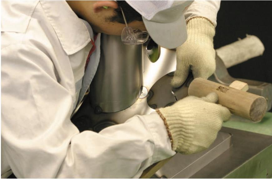
図9 - 148 仮付け溶接途中の形状修正
