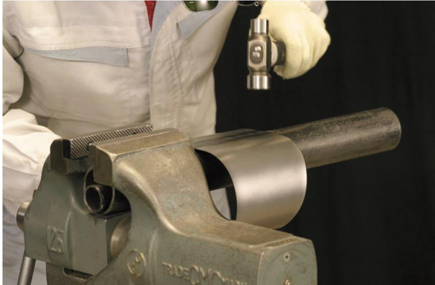
図9 - 35 楕円筒の仮付け溶接部のならし
