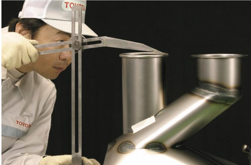
図9 - 97 中間体と円筒の組み付け高さ確認
