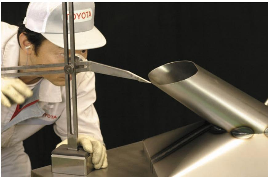
図9 - 82 ベースと中間体本溶接後の寸法確認
