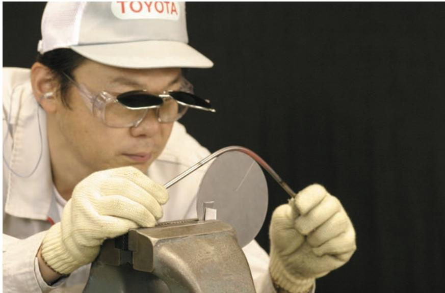
図9 - 47 ワイヤリング用丸棒の曲げ（その2）
