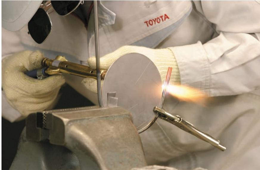
図9 - 49 ワイヤリング用丸棒の曲げ（その4）
