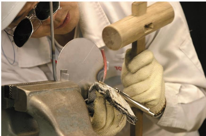
図9 - 50 ワイヤリング用丸棒の曲げ（その5）
