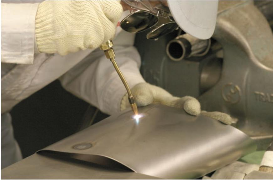
図9 - 73 中間体の仮付け溶接
