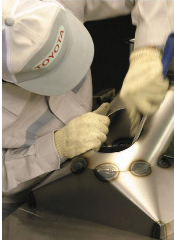
図9 - 105 中間体接合面の調整
