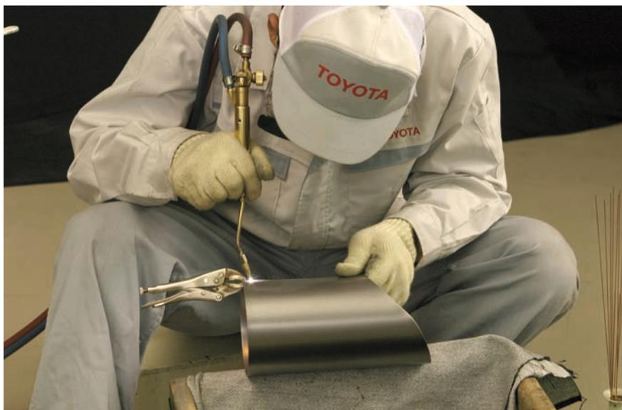
図9 - 127 円筒の仮付け溶接
