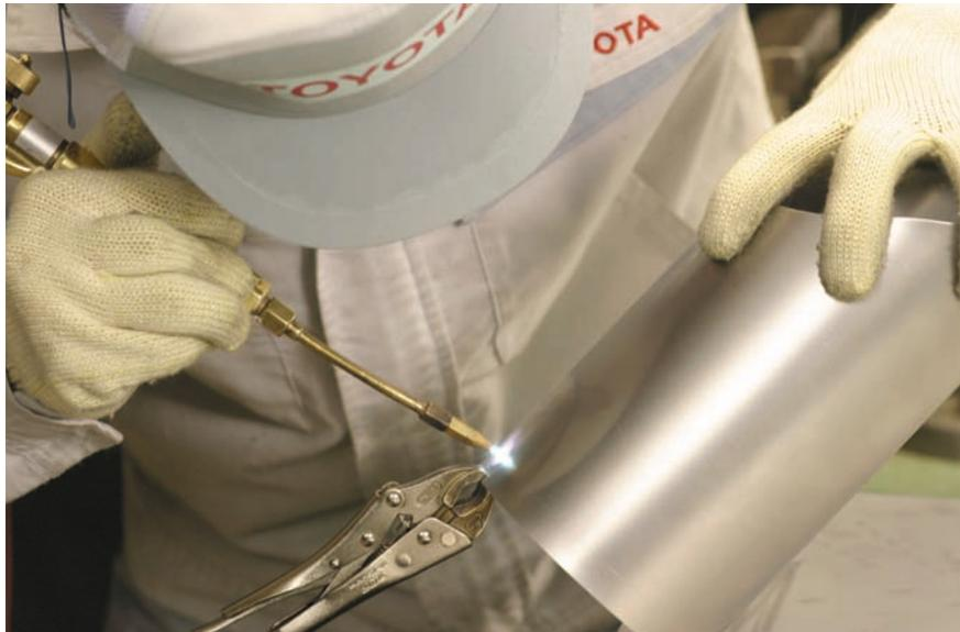
図9 - 55 円筒の仮付け溶接
