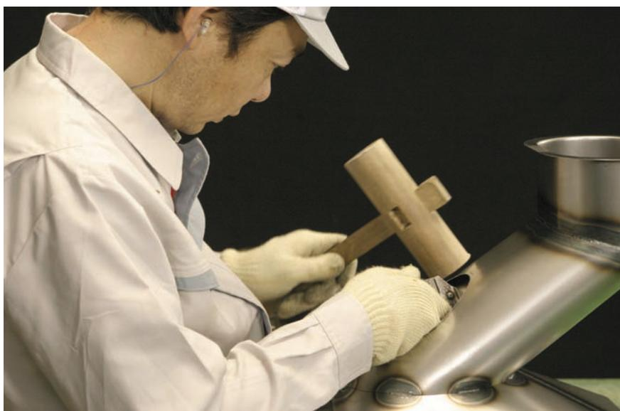
図9 - 104 中間体の穴あけによるひずみ修正
