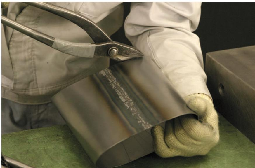
図9 - 135 中間体の寸法調整
