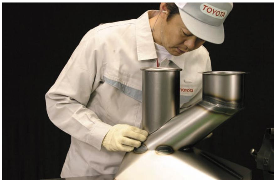
図9 - 95 中間体と円筒の接合面の確認・修正
