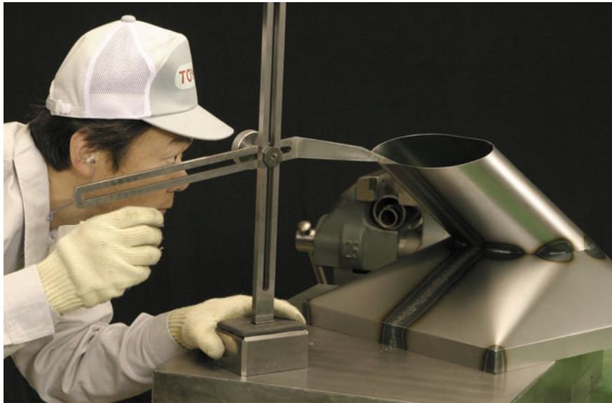
図9 - 85 中間体と楕円筒の組み付け位置確認（その1）
