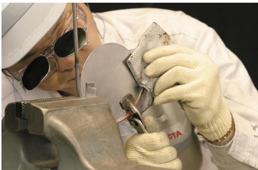
図9 - 48 ワイヤリング用丸棒の曲げ（その3）
