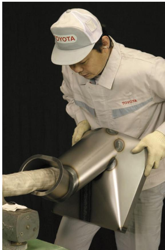
図9 - 92 溶接後の形状修正
