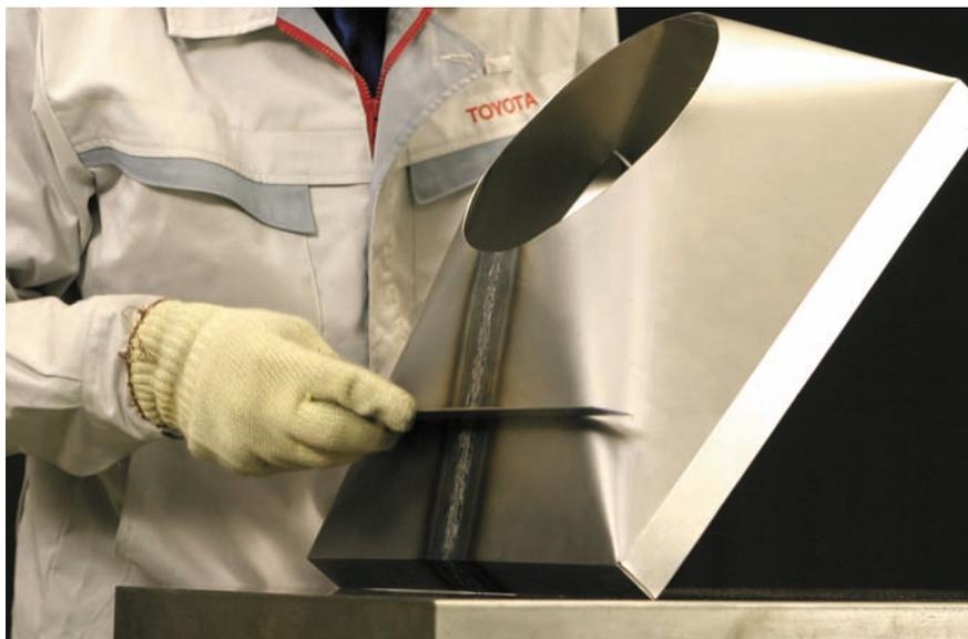
図9 - 119 ベースの修正と平面出し
