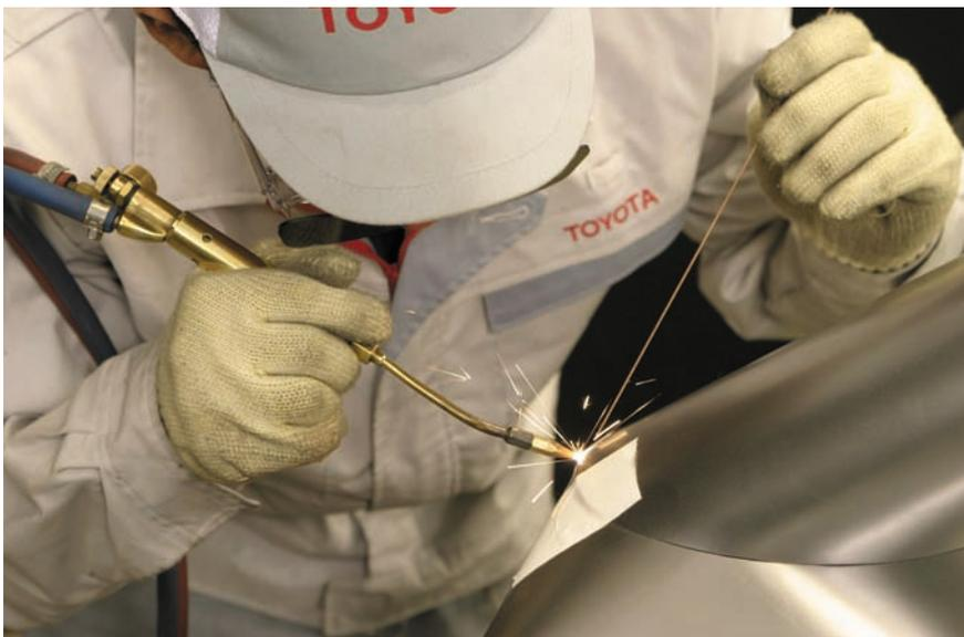
図9 - 137 ベースと中間体の仮付け溶接
