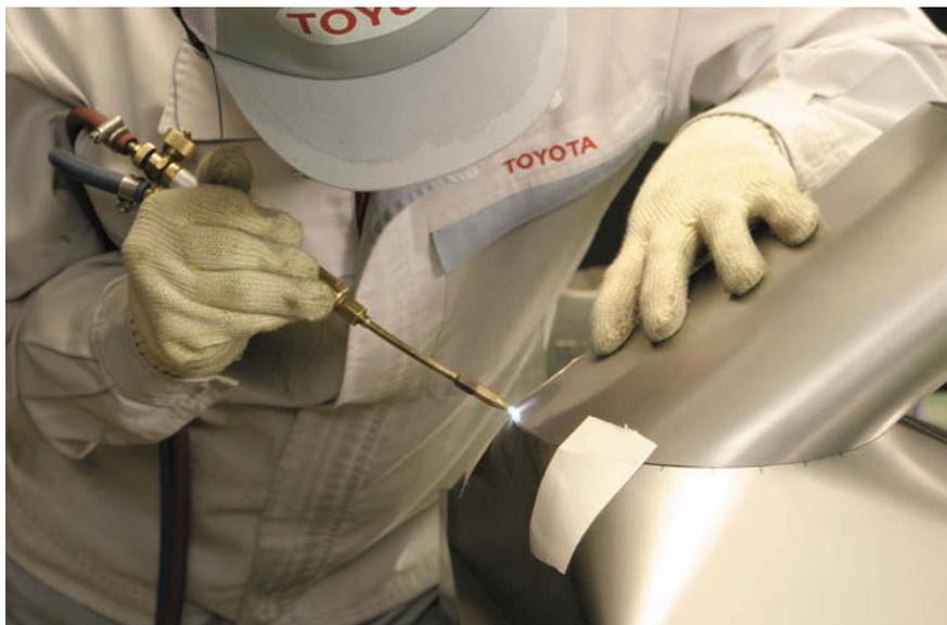
図9 - 80 ベースと中間体の仮付け溶接
