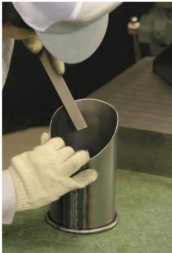
図9 - 100 円筒溶接面の調整
