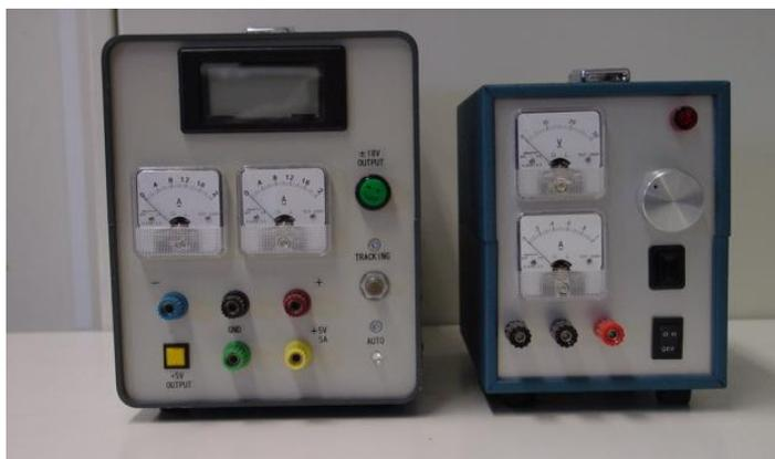
図1 デュアルトラッキング電源装置の完成品例
