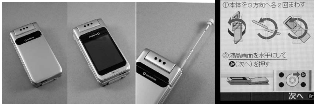
モーションコントロールの携帯電話への搭載例
