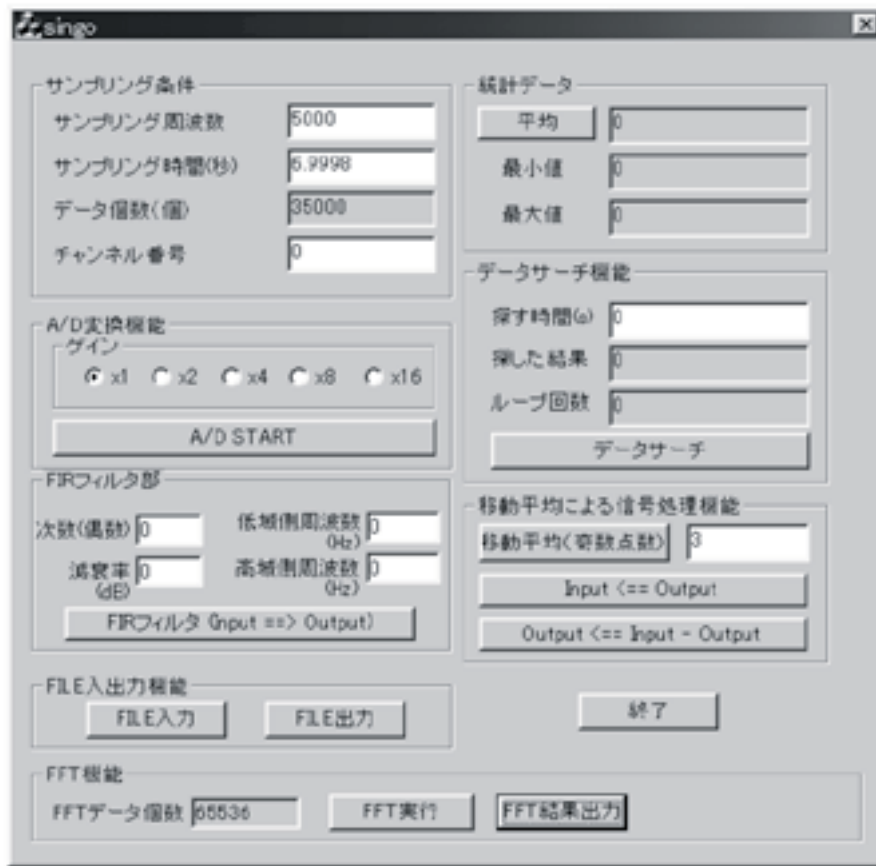
図13 FIRフィルタ、FFTの機能を組み込んだプログラムのダイアログ画面
