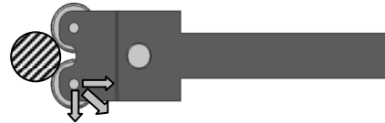
図 14 アヤ目用工具が受ける切削抵抗およびその反力の方向
