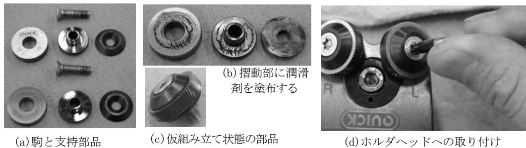
付図2 駒の組み付け作業
