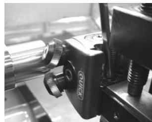
付図5 心高さの微調整作業
