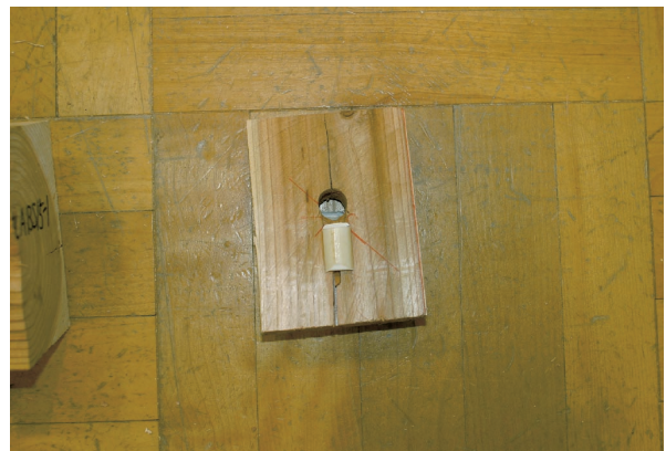
写真4 丸込栓の破断 (ABS樹脂)
