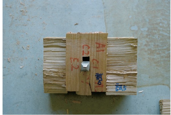
写真2 長ホゾの底抜け破壊 (鋼材)
