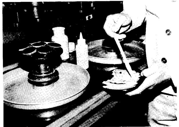
写真 1-21 研磨皿に研磨液をつける
