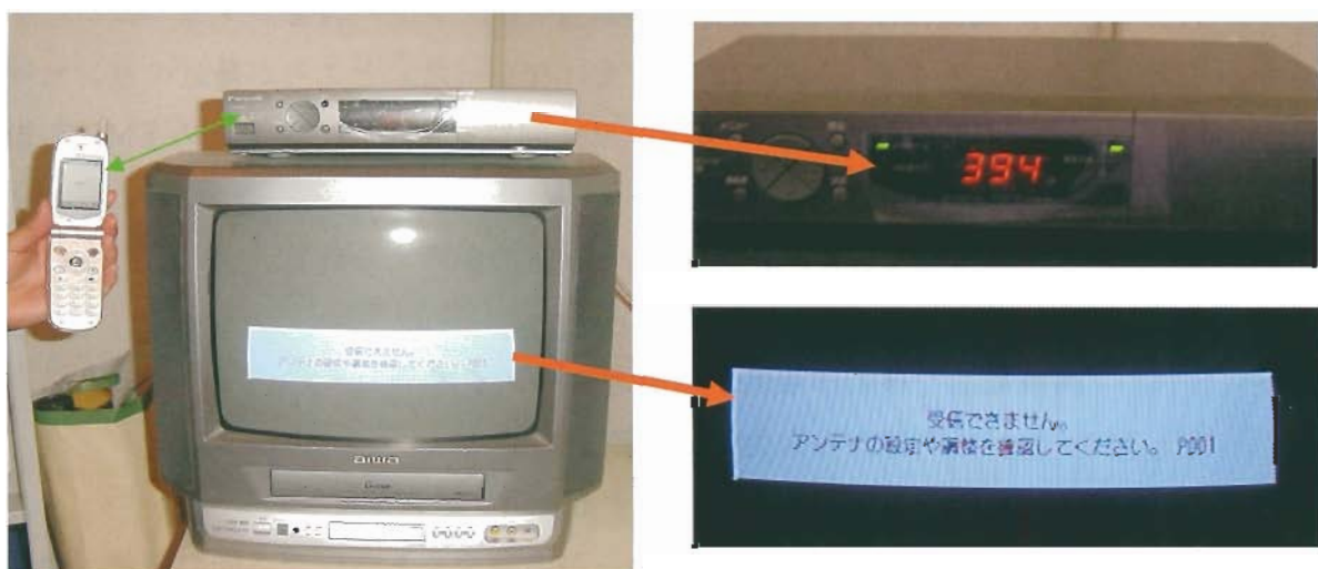
図 1-4 携帯電話を使用した時の CS 放送受信障害 (例)
