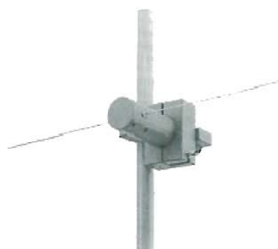
図4-12 アクティブダイポールアンテナの例 周波数範囲：10kHz～30MHz
