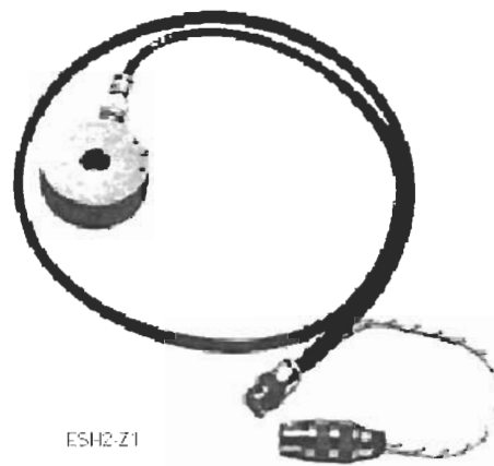
図4-29 RF カレントプローブの例 (VDE0871 準拠)
