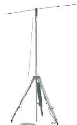
図4-11 半波長ダイポールアンテナの例 周波数範囲：25MHz～1000MHz
