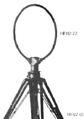
図4-9 ループアンテナの例 周波数範囲：9kHz～30MHz
