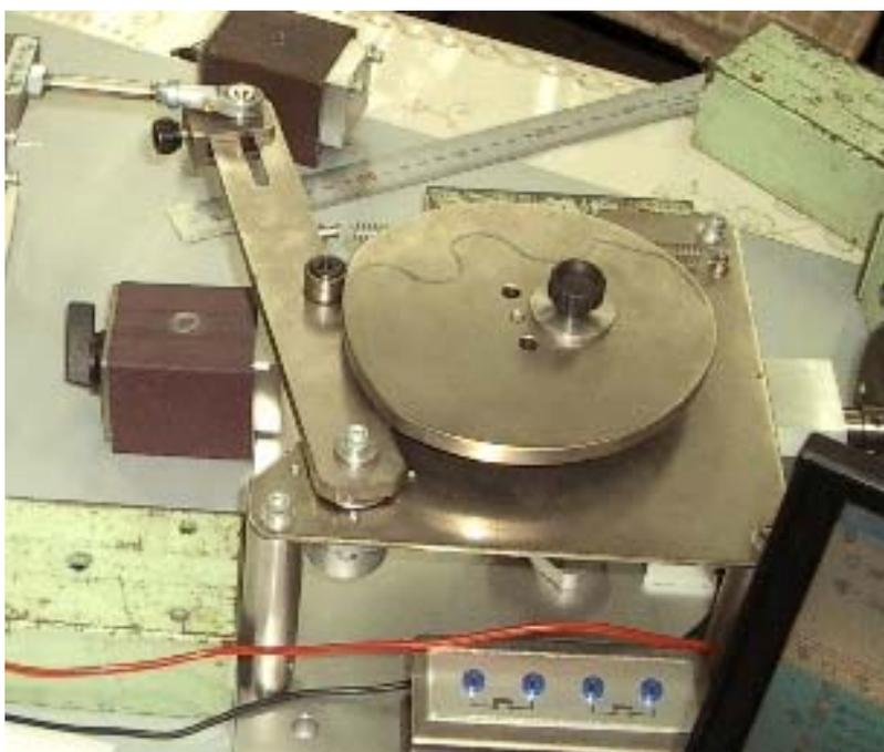
図 7-4 写真イメージ (平カムモジュール部分のみ)
