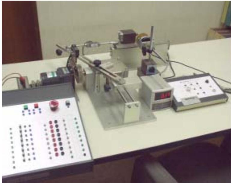
図7-51 写真イメージ（アジャスタブル型レバースライダ）
