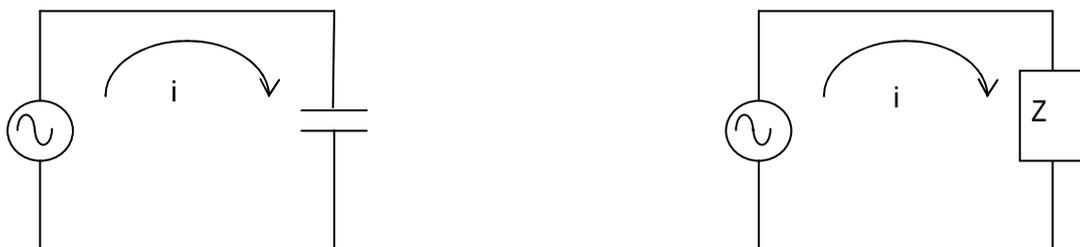
図10 マックスウェルの変位電流
