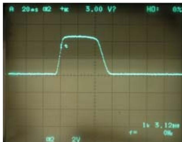
図8 静電誘導に基づくノイズの測定結果
