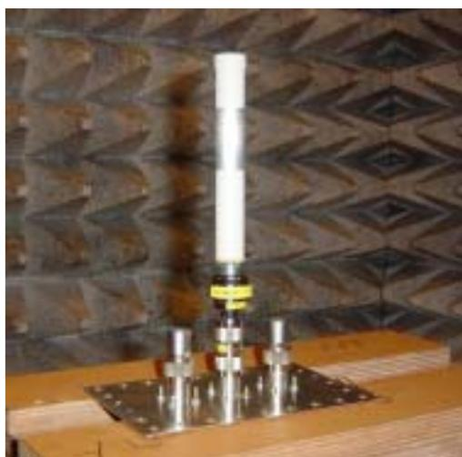
図 4 基準受信レベルの測定
