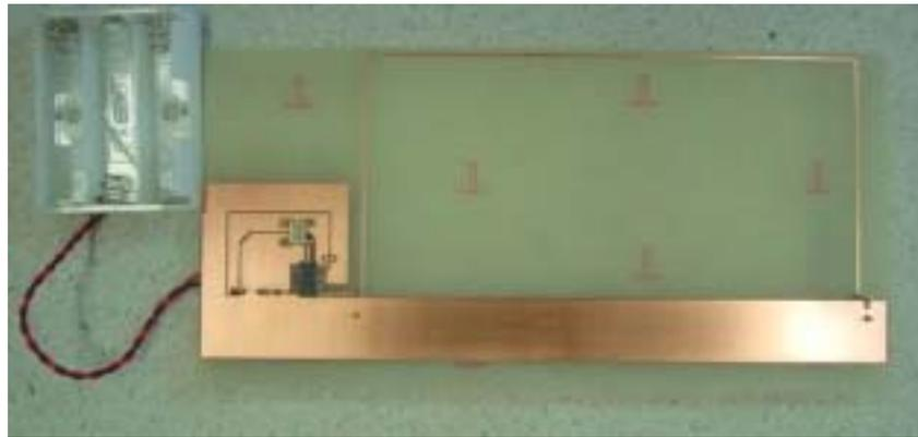
図 18 伝送ループ配線大の場合のプリント基板
