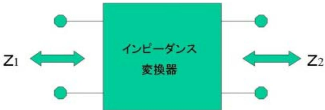
図 2 インピーダンス変換器
