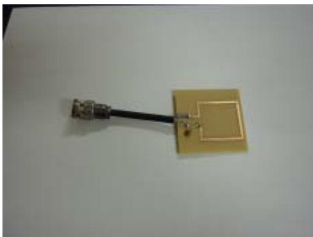
図8 試作アンテナへのコネクタ付け及び共振周波数調整
