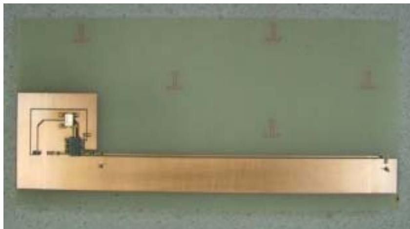
図 17 伝送ループ配線小の場合のプリント基板
