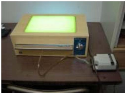
図4 露光装置
