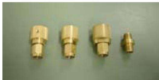
図1 特性が保証された校正用コネクタ類
