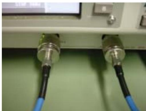
図2 N/SMA 変換コネクタとケーブルの接続
