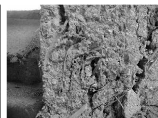
写真-7 中塗用土 ワラスサ混入状況
