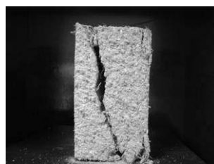
写真-6 中塗用土 圧縮試験後 試験体ハ
