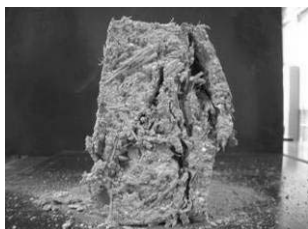
写真-4 荒壁用土 圧縮試験後 試験体イ
