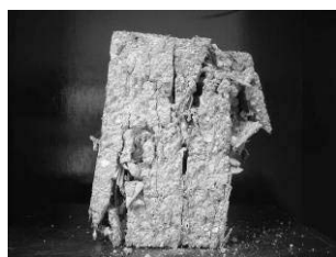
写真-8 荒壁・中塗用土一体 圧縮試験後 試験体イ
