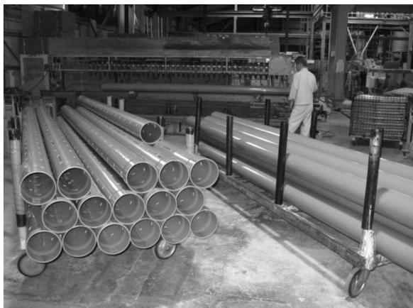
図4 穴あけ作業およびパイプストック
