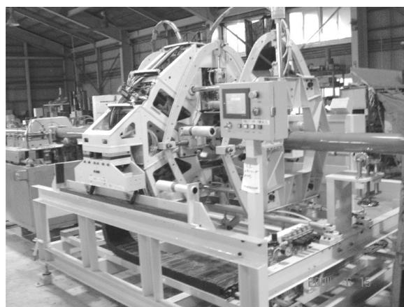
図6 開発したパイプ穴あけ装置
