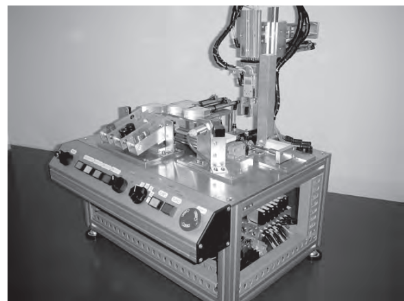
図1 標準課題：空気圧FAシステムの設計・製作
