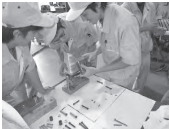
図8 プレス金型部品と組立調整の様子
