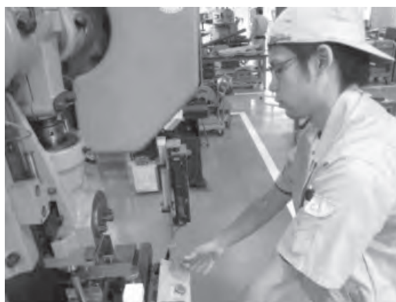
図9 プレス金型による穴抜き
