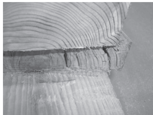
写真3 側材(スギ)内部破壊性状
