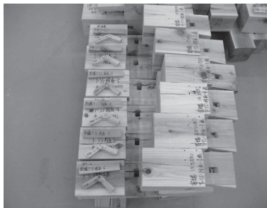
写真 7 込栓・楔・ほぞ破壊状況
