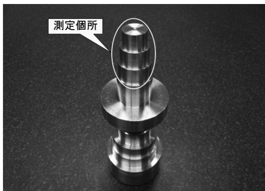
図2 測定物と測定箇所
