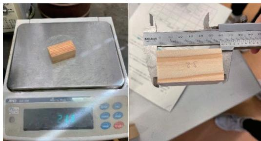
図3 木材の質量と寸法の測定
