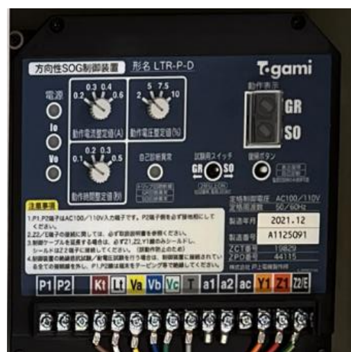
図1-2-2 SOG制御装置
