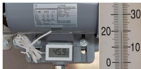
図 29 定格負荷運転 30 分後の表面温度 (周囲温度 20°C)
