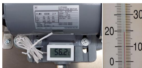
図 31 定格運転→過負荷運転トリップ時の表面温度（周囲温度 20°C）
