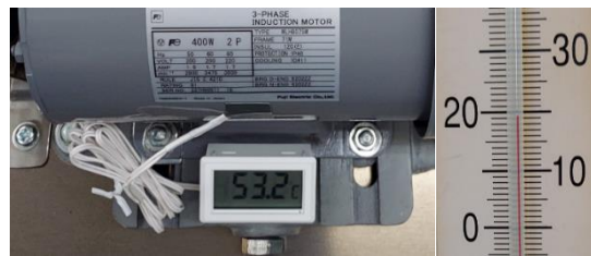
図 33 定格運転→過負荷運転トリップ時の表面温度（周囲温度 20°C）
