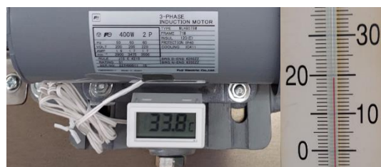
図27 軽負荷運転30分後の表面温度（周囲温度20°C）
